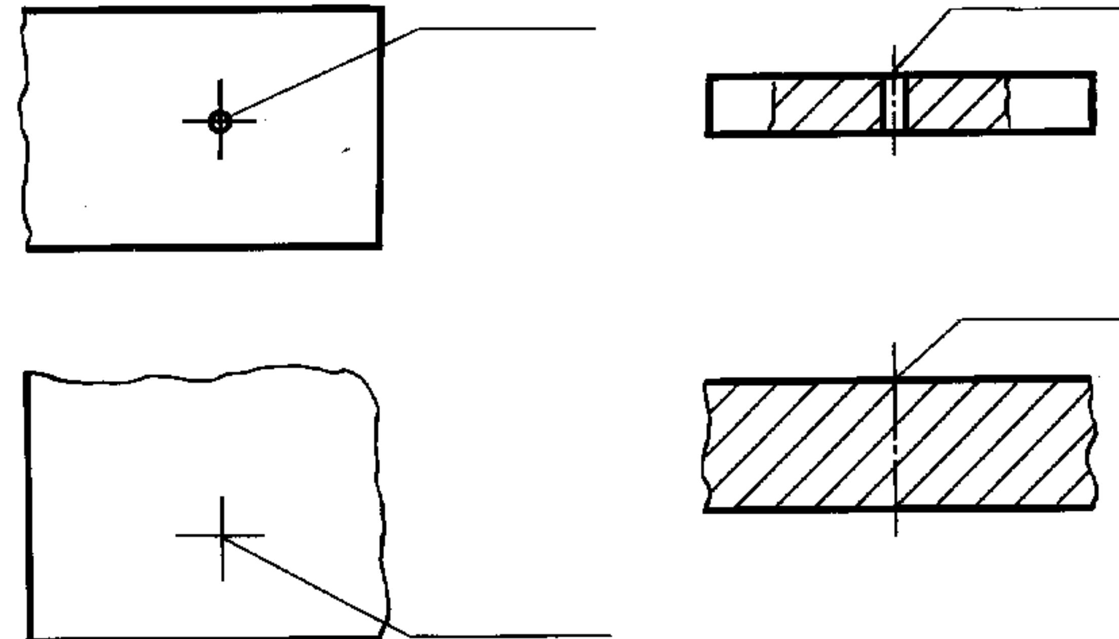
4. Примеры упрощенного нанесения размеров отверстий приведены в таблице.
