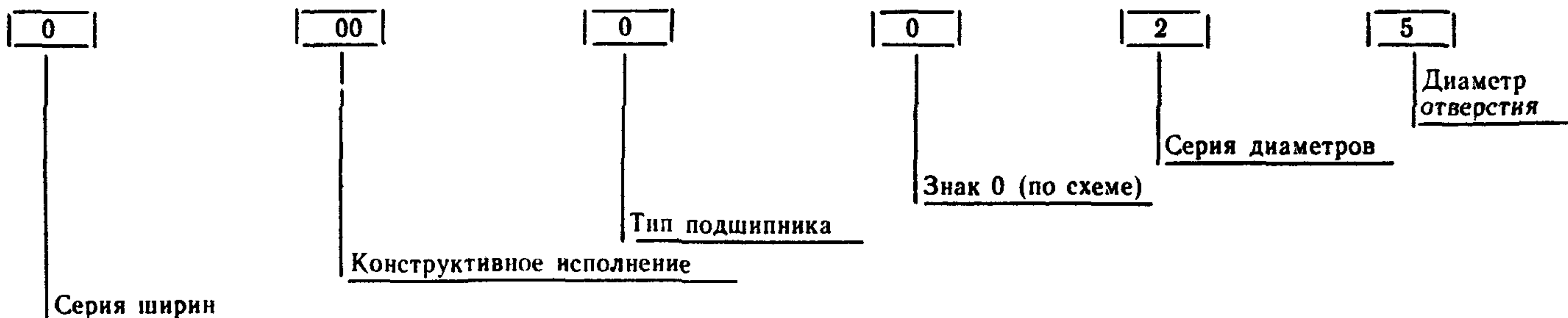
Подшипник 184009/1,5 — радиальный шариковый однорядный с упорным бортом на наружном кольце
