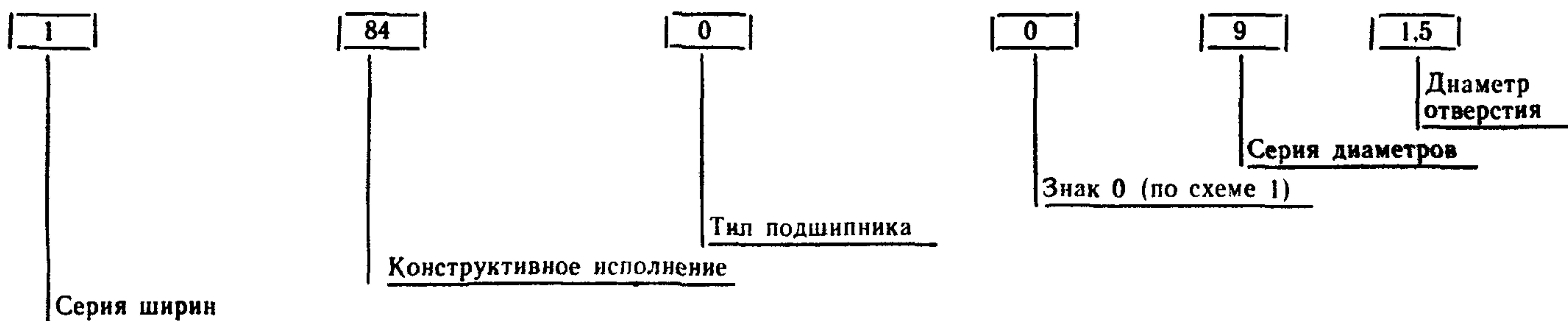
Подшипник 184009/1,5 — радиальный шариковый однорядный с упорным бортом на наружном кольце
