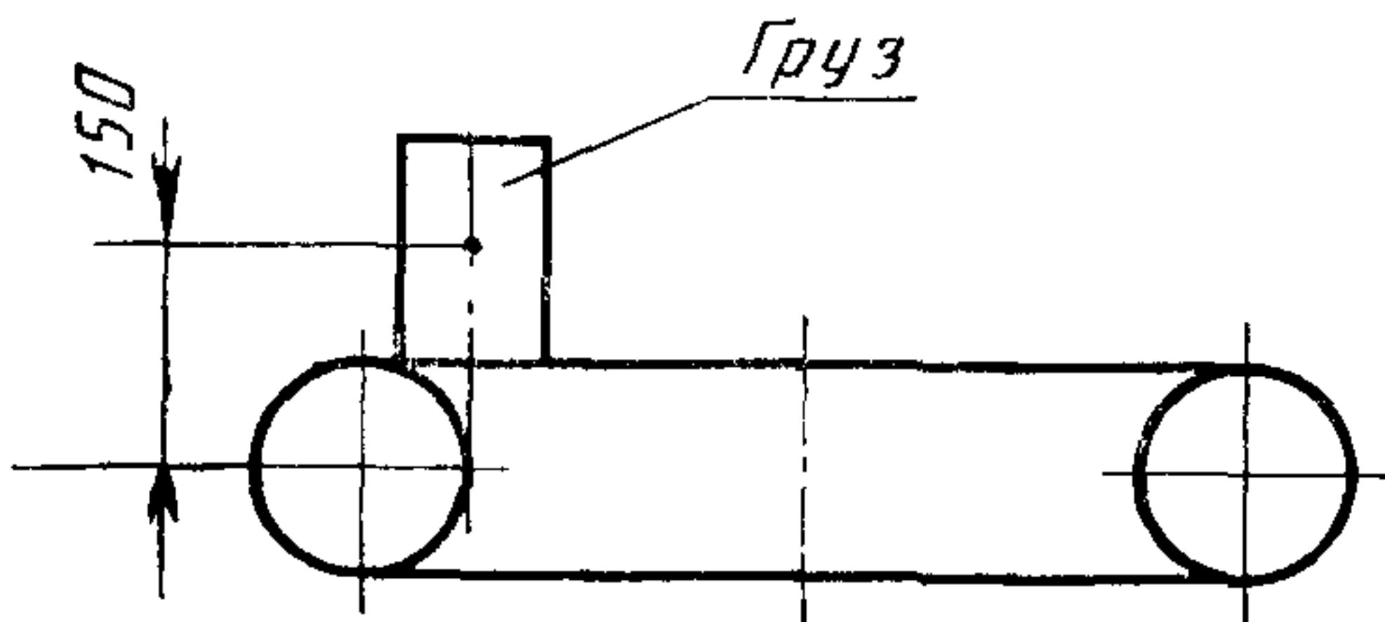
4.2. При повреждении одного из отсеков минимальный запас плавучести надувной лодки должен составлять не менее 50% номинальной грузоподъемности.
