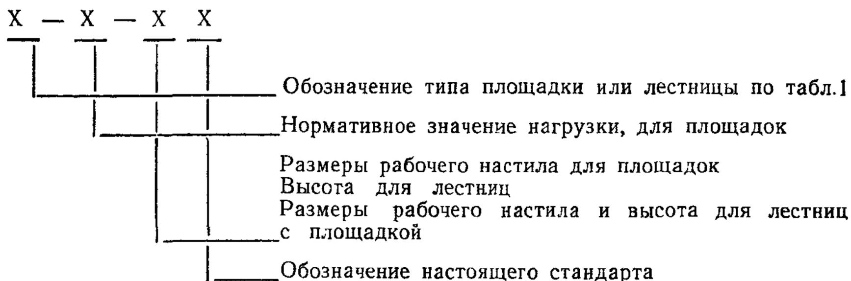
Пример условного обозначения площадок, навешиваемых на лестницы, из алюминиевых сплавов с нормативным значением нагрузки 1000 Н и размерами рабочего настила 0,6 × 0,6 м:
