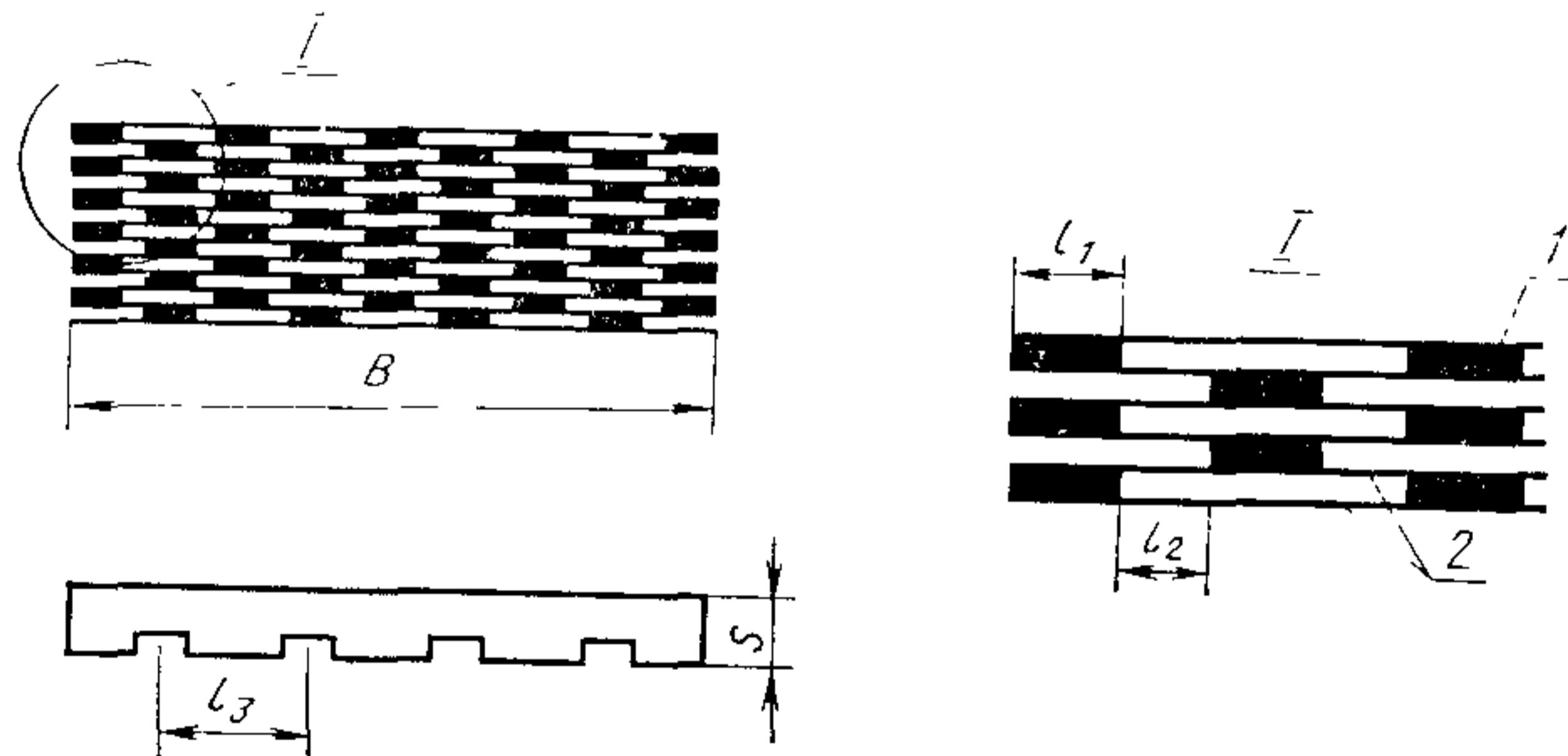
B—ширина; S—толщина;  $l_1$ —ширина клеевых полос;  $l_2$ —расстояние между смежными клеевыми полосами;  $l_3$ —расстояние между прорезями; 1—клеевой шов; 2—листы бумаги
