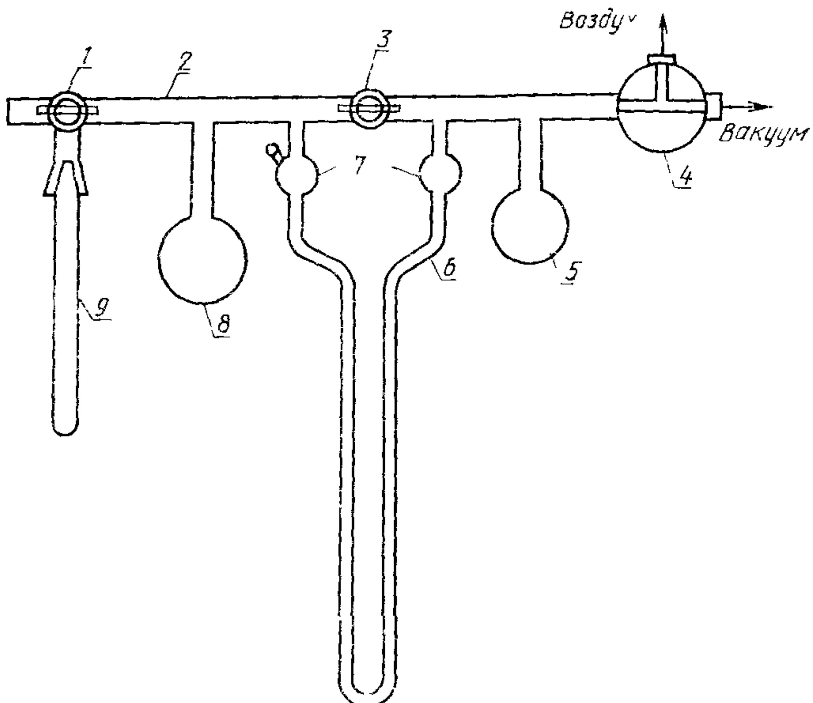
рообразными расширениями 7 в верхней части для улавливания масла; пробирки 9 для образца длиной 180 мм внешним диаметром 17—18 мм; вакуумного насоса типа НВР по ГОСТ 14707—82 или другого, имеющего аналогичные характеристики; нагревательного устройства; автотрансформатора регулировочного типа ЛАТР-2; ртутного манометра с ценой деления шкалы 1 мм, термометра по ГОСТ 215—73 группы I № 4 или 5.
