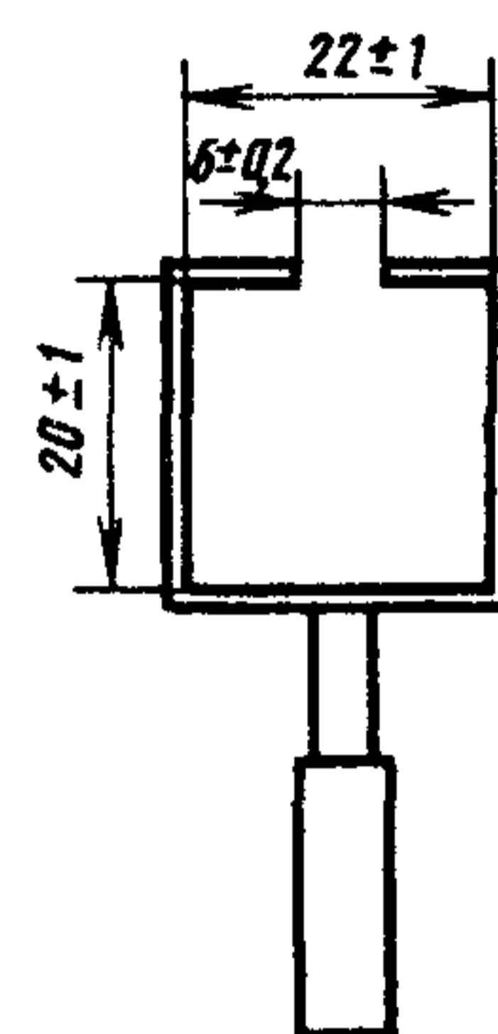
2.5. Приспособление, обеспечивающее надежный захват шпильки при ее вырывании, например, сверлильный трехкулаковый патрон. Приспособление устанавливают при помощи хвостовика в верхнем зажиме разрывной машины.
