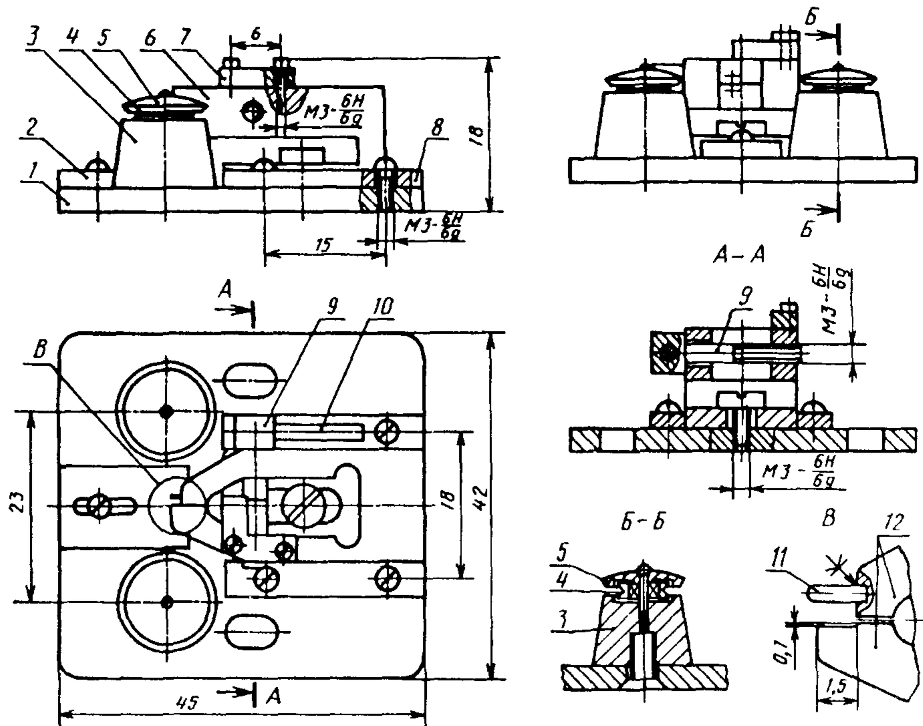
1 — основание, 2 — направляющая, 3 — конус, 4 — ролик, 5 — крышка, 6 — корпус,
