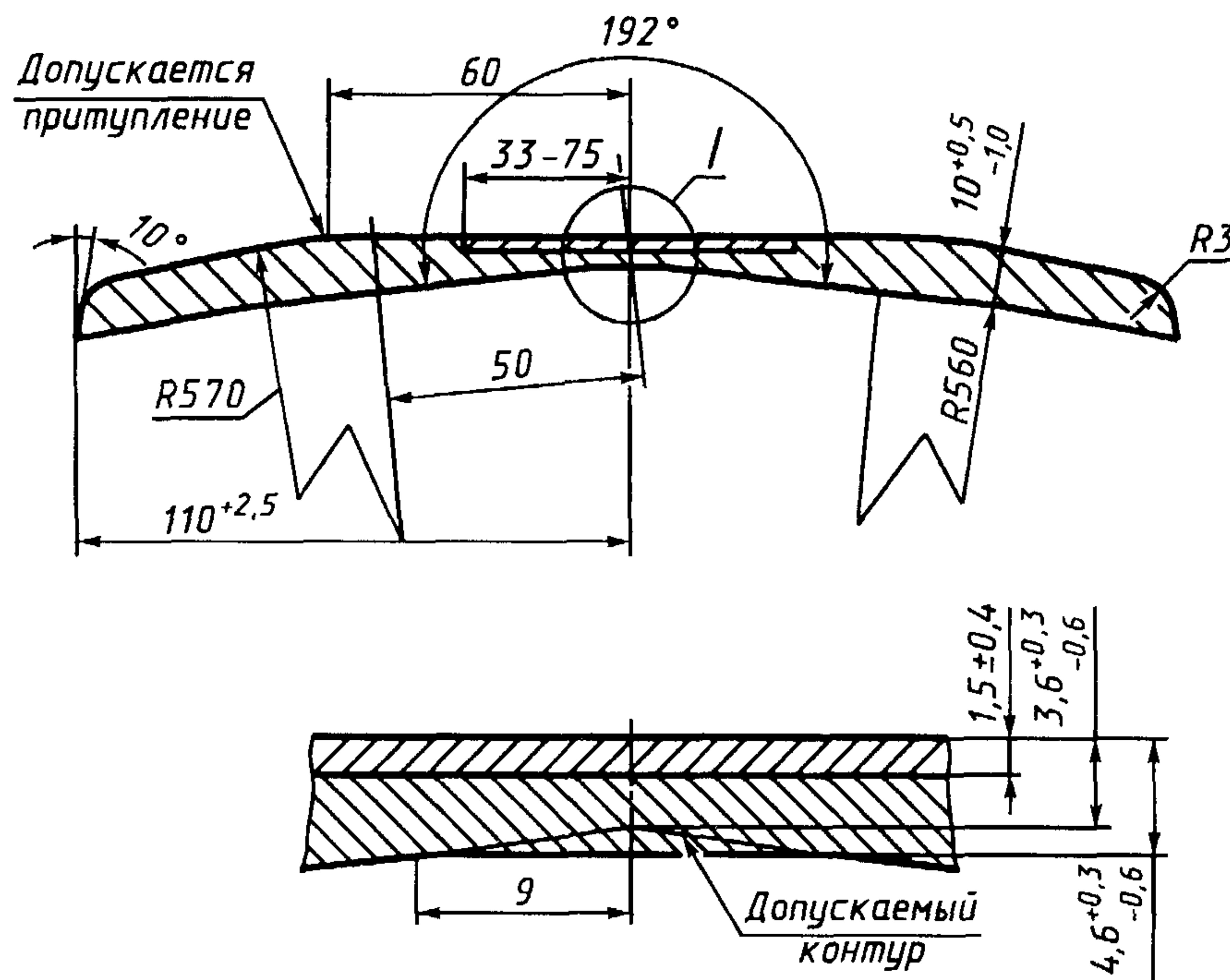
1.4 Допускается увеличение или уменьшение радиуса рабочей поверхности полосы по сравнению с указанным на чертеже
