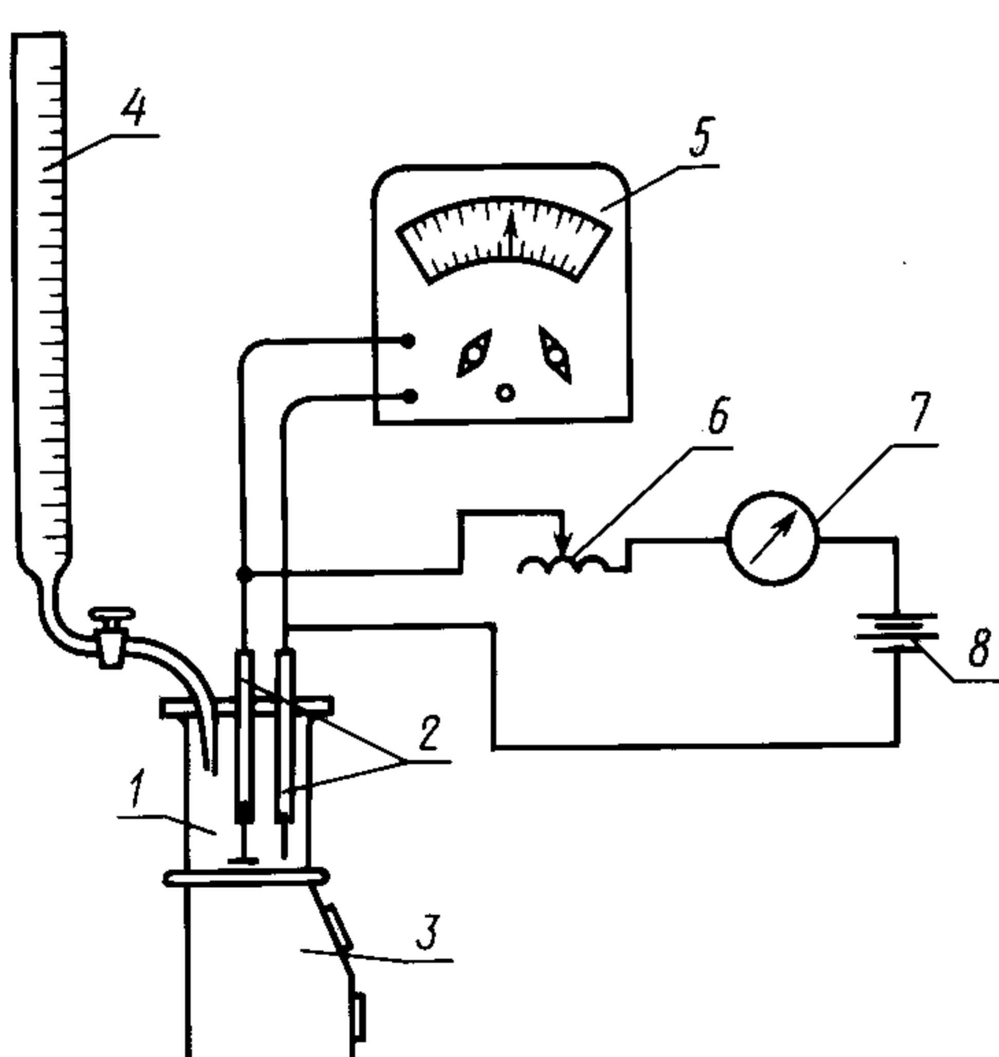
Установка для титриметрического определения алюминия с ампераметрической индикацией конца титрования (см. чертеж).
