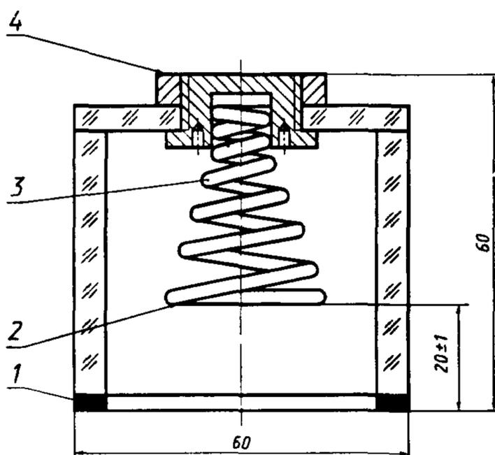
1 — прокладки; 2 — пластина; 3 — пружина; 4 — контакт
