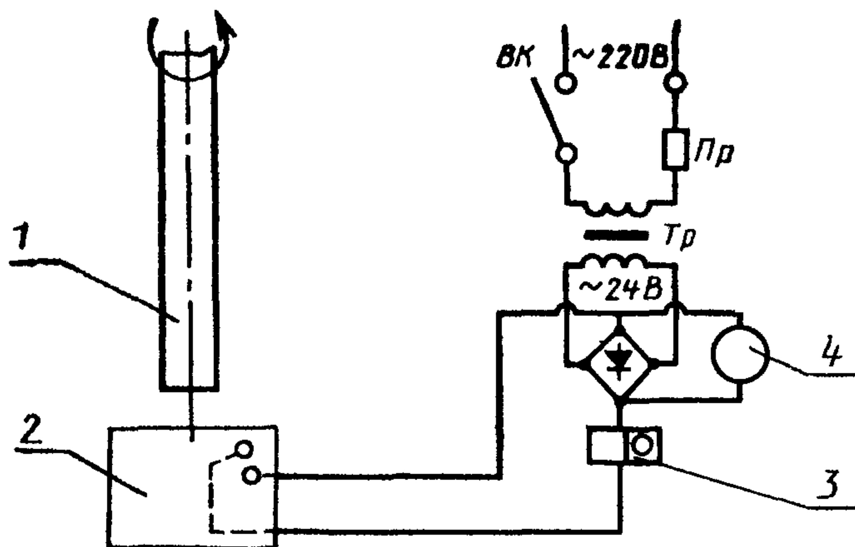
1—буровой став; 2—датчик импульсов, 3—счетчик импульсов, 4—
