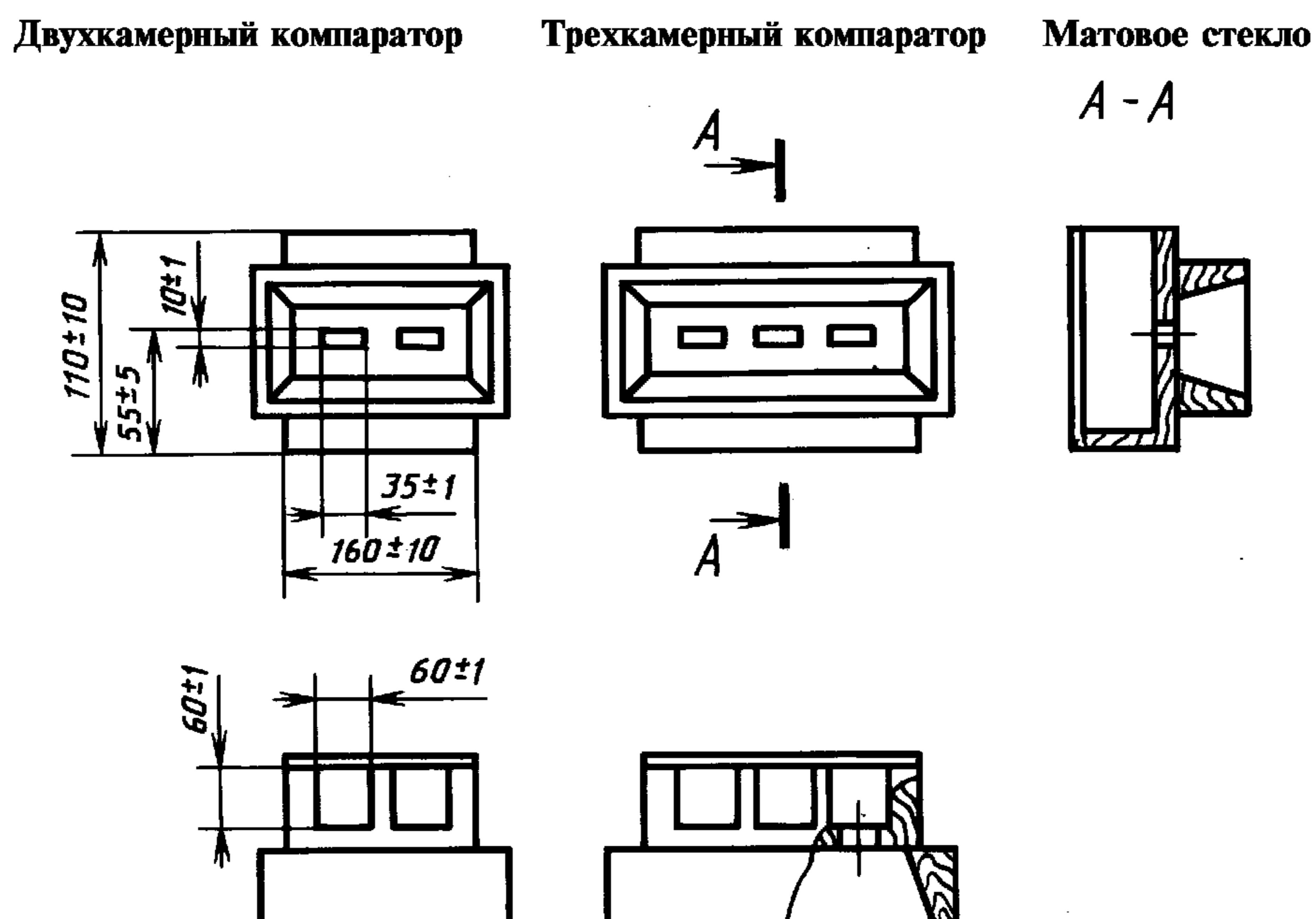
П р и м е ч а н и е. Компаратор изготавливают из дерева, пластмассы, металла или других материалов.
