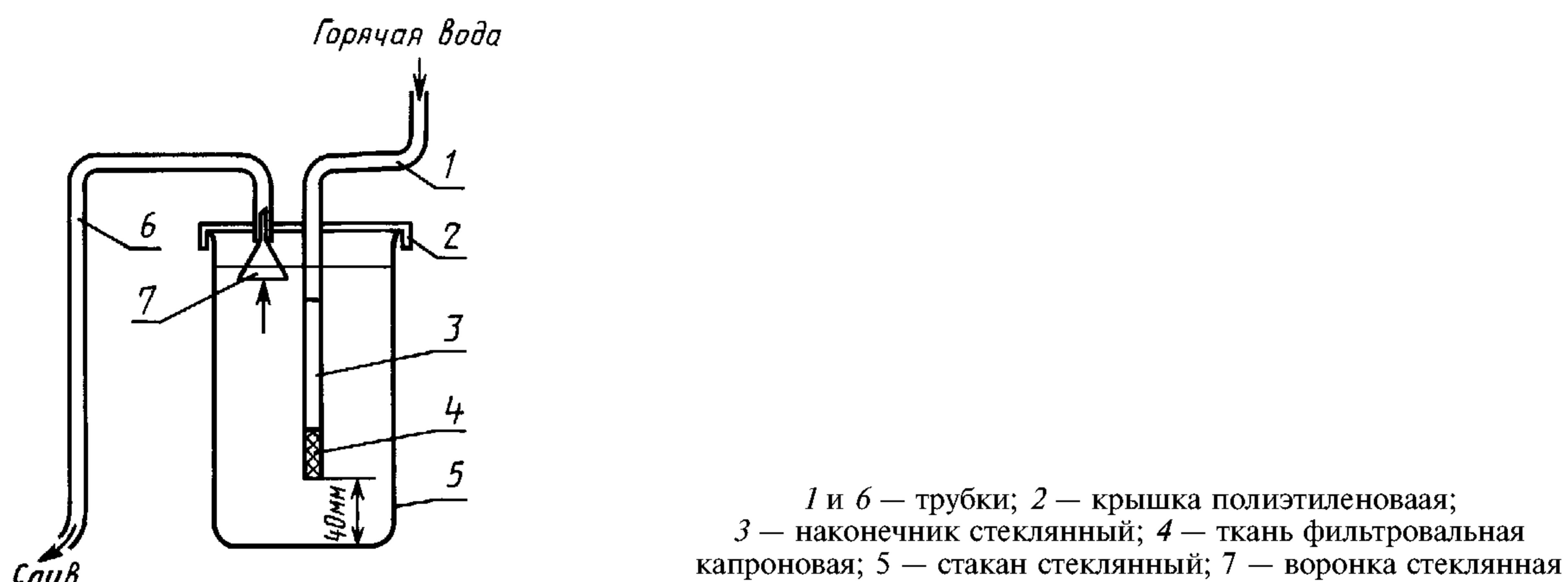
Установка состоит из стеклянного стакана вместимостью 600 см<sup>3</sup> и полиэтиленовой крышки с двумя резиновыми или полихлорвиниловыми трубками. Первая трубка одним концом присоединяется к водопроводному крану с горячей водой, другим концом — со стеклянным наконечником, конец которого обернут фильтровальной капроновой тканью для улавливания случайных загрязнений, опущена в стакан. На конце другой трубы для слива вставлена воронка.
