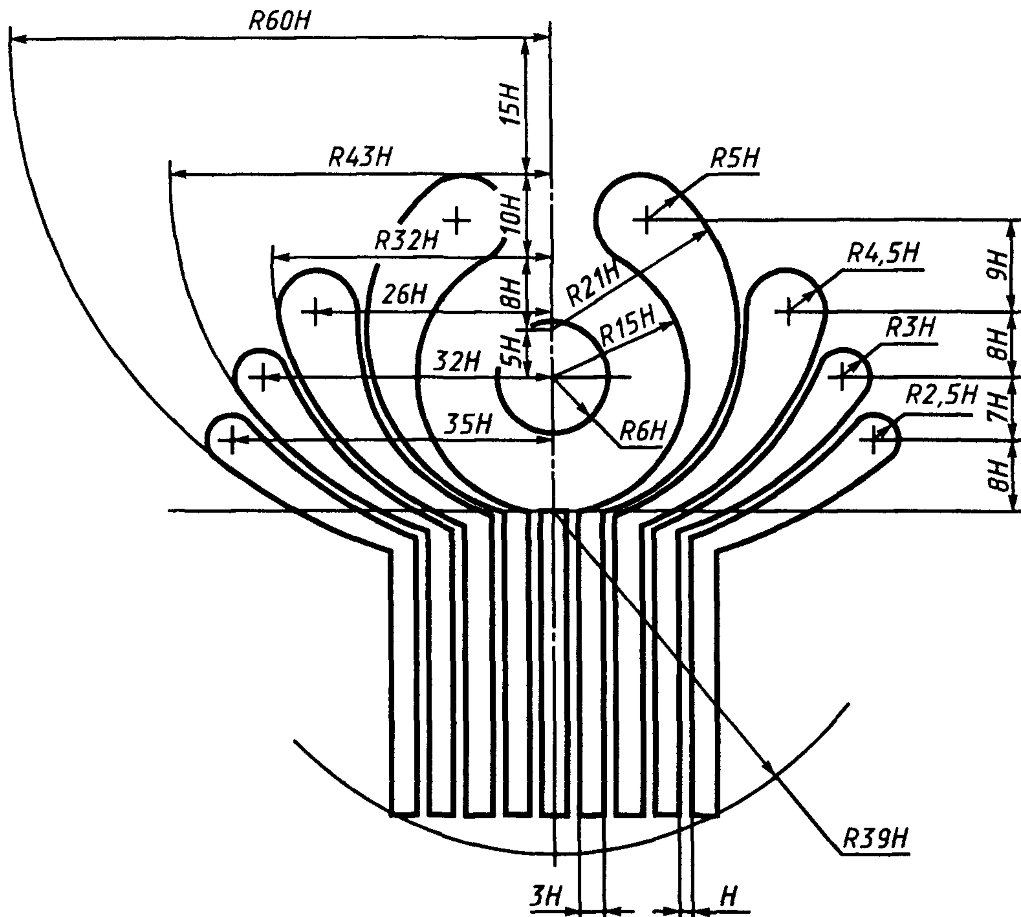
$H$  — размер просвета, принимаемый за основу при построении
