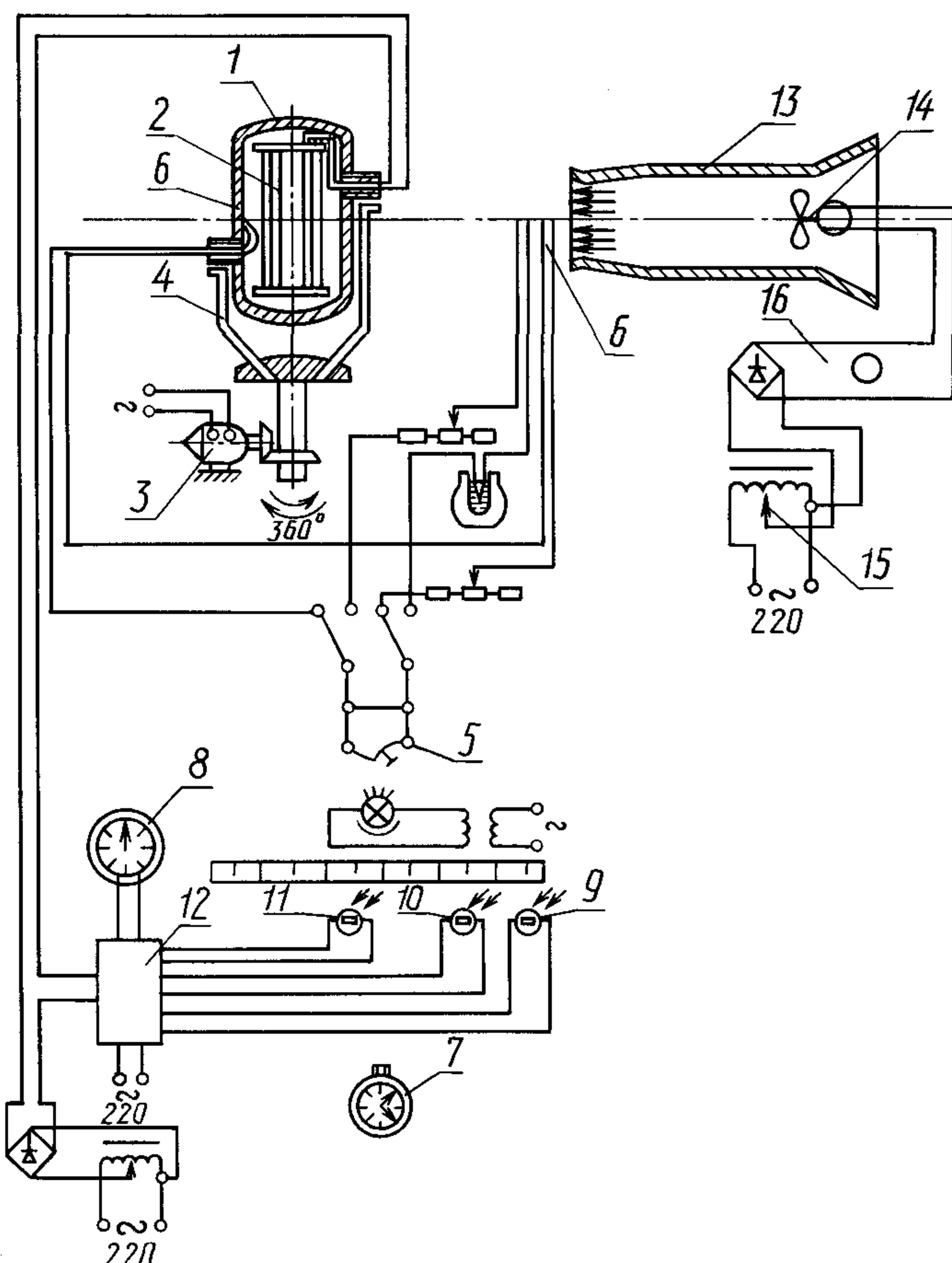
Аэродинамическое устройство состоит из трубы 13 и вентилятора 14 с мотором и служит для создания воздушного потока заданной скорости. Скорость потока регулируют автотрансформатором 15 и устанавливают с помощью вольтметра 16, отградуированного в показателях скорости потока с ценой деления 0,1 м/с. Ось трубы должна проходить через центр бикалориметра, расположенного вертикально.
