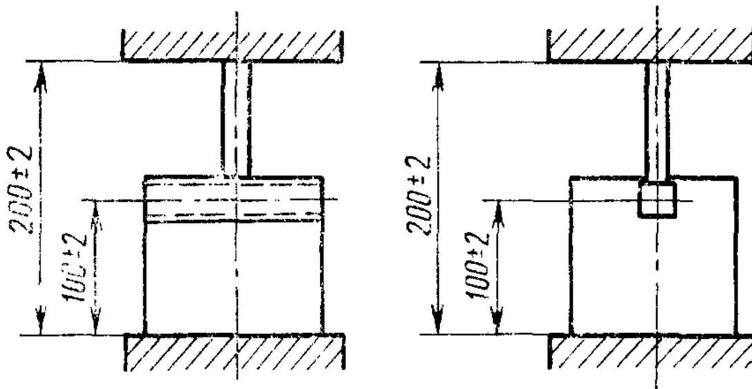
Допускается симметричная обрезка углов образца, закрепляемого в нижнем зажиме разрывной машины, при применении зажима длиной менее 100 мм.
