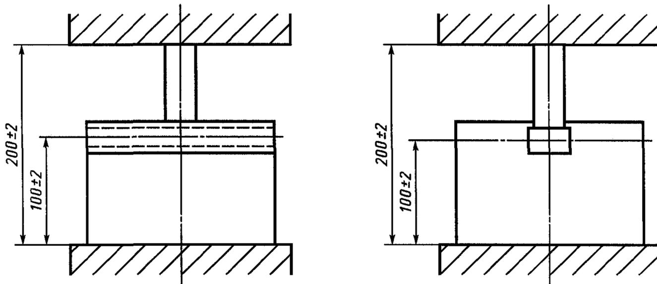
Рисунок 1 — Закрепление образцов узлов крепления
