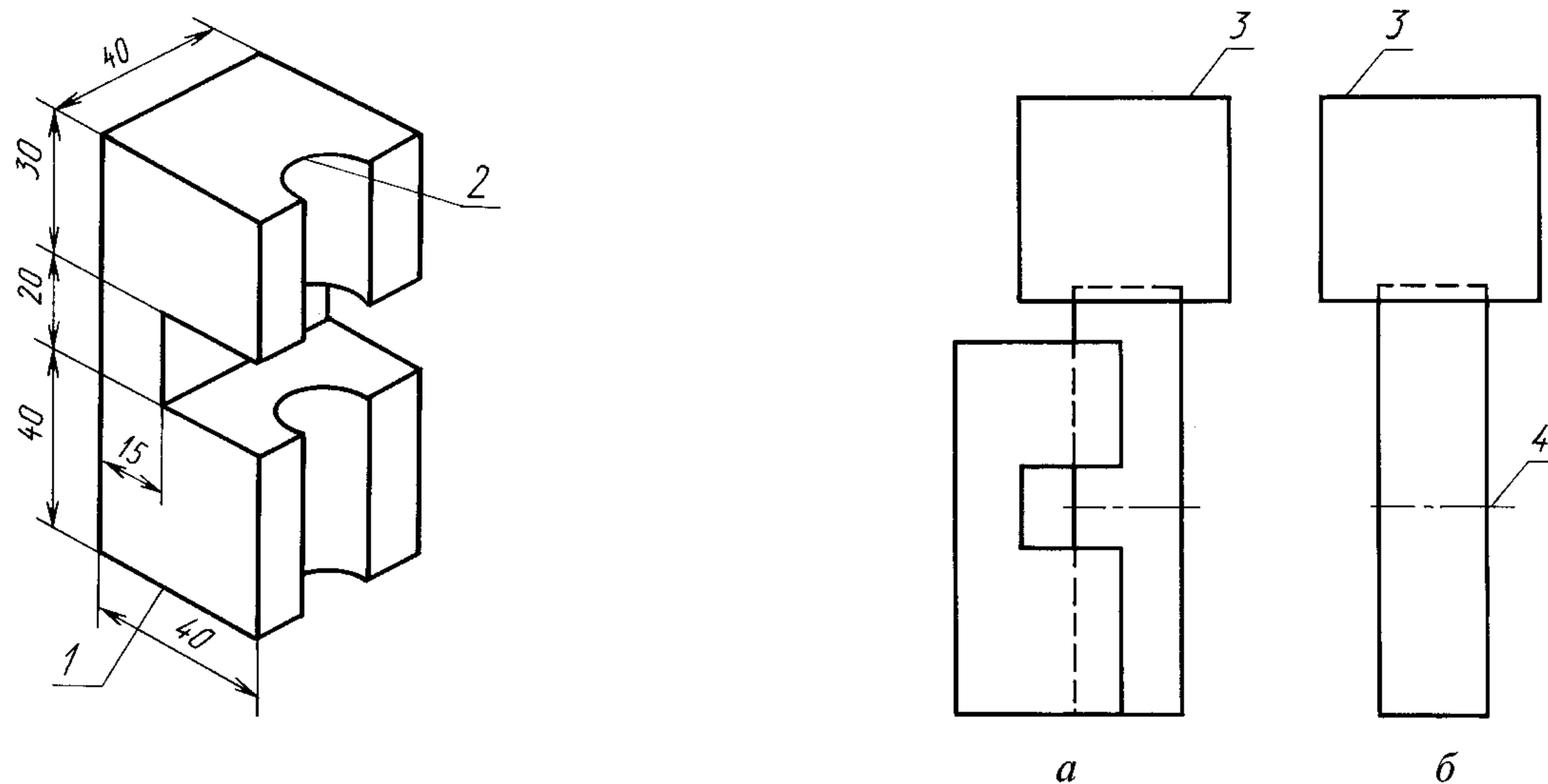
1 — зажимное устройство; 2 — полуокружность для обеспечения плотного прилегания цилиндра
