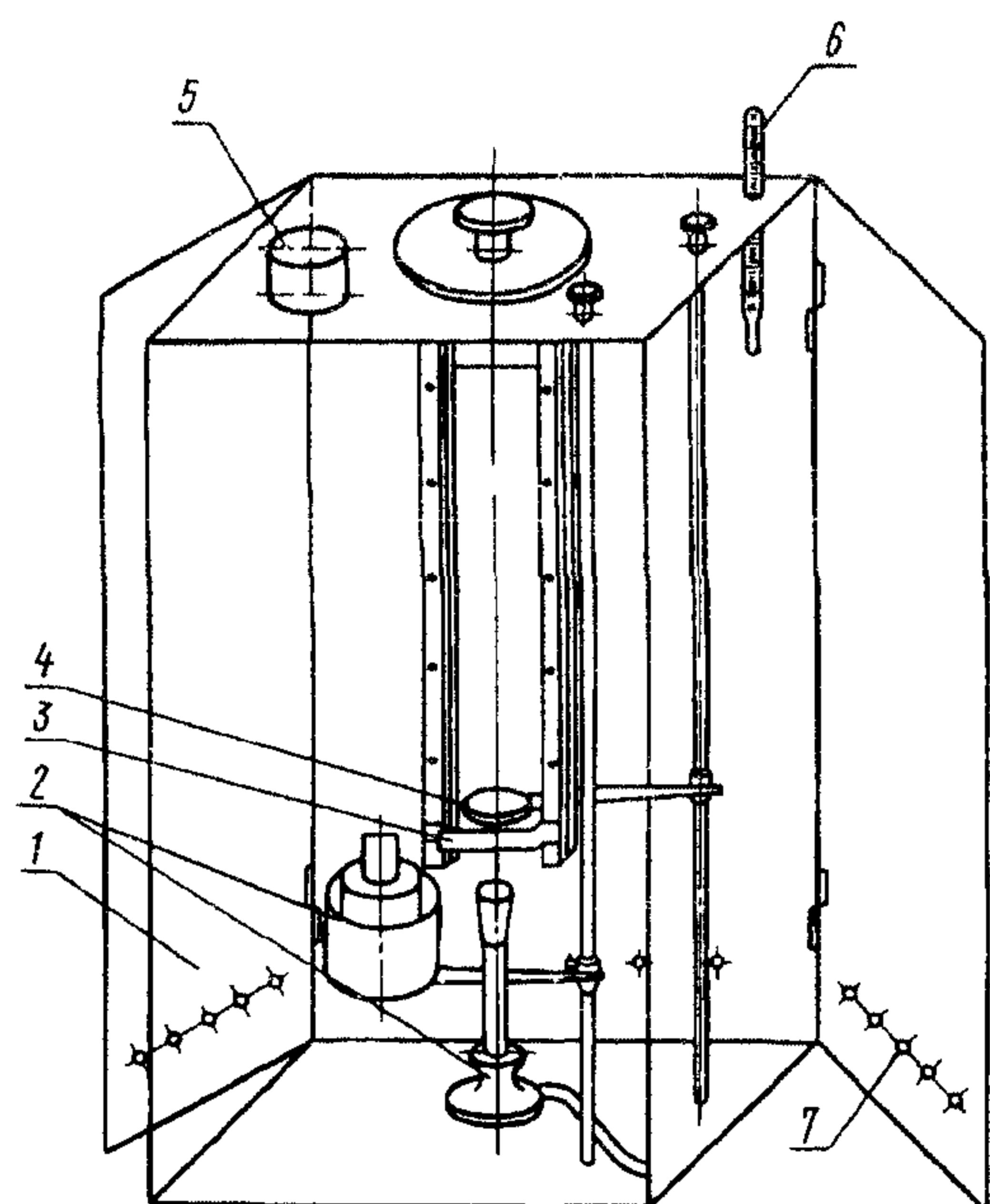
также в боковых дверцах имеются отверстия 7, регулируемые задвижками, а для создания тяги — труба 5 высотой 30 мм с крышкой, расположенная в верхней части прибора.
