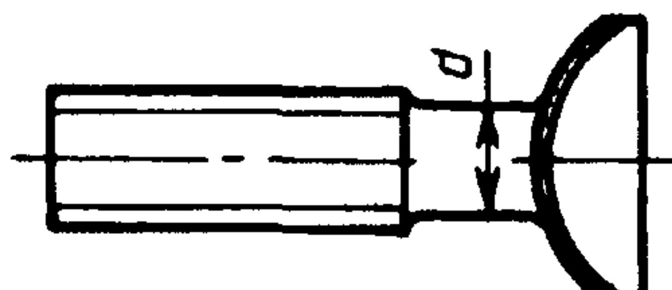
**Вариант изготовления болта с облегченной головкой для исполнений 1 и 2**
