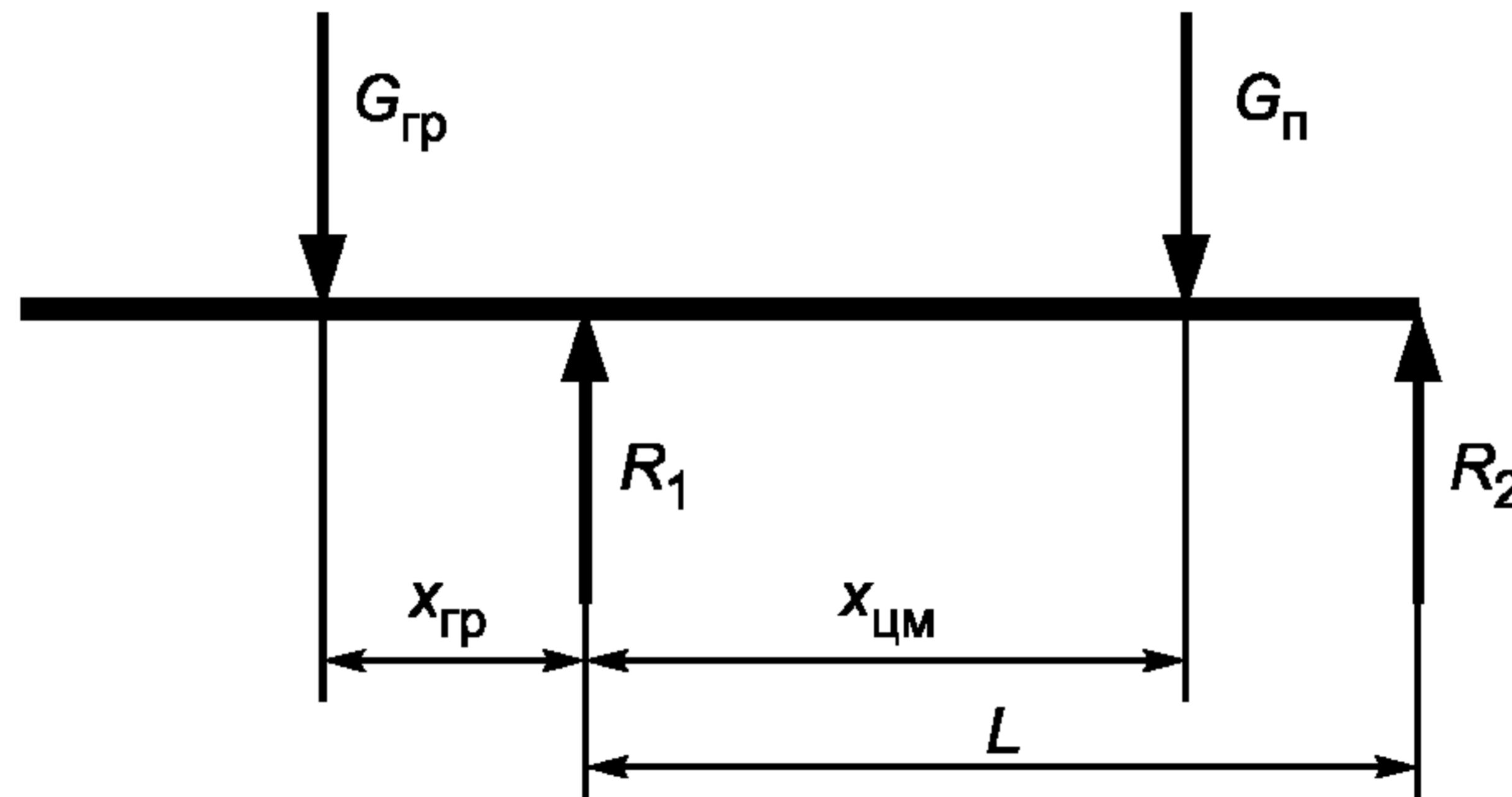
$G_{rp}$  — масса груза;  $G_\pi$  — масса погрузчика;  $L$  — база погрузчика;
