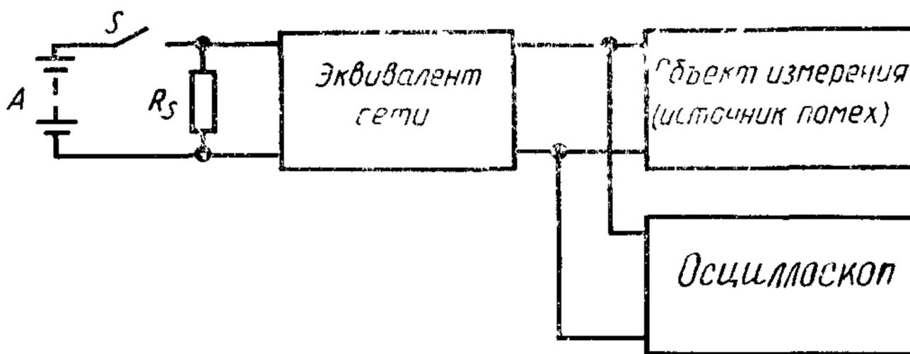
А—аккумулятор, S—мощный выключатель,  $R_s$ —нагрузочное сопротивление
