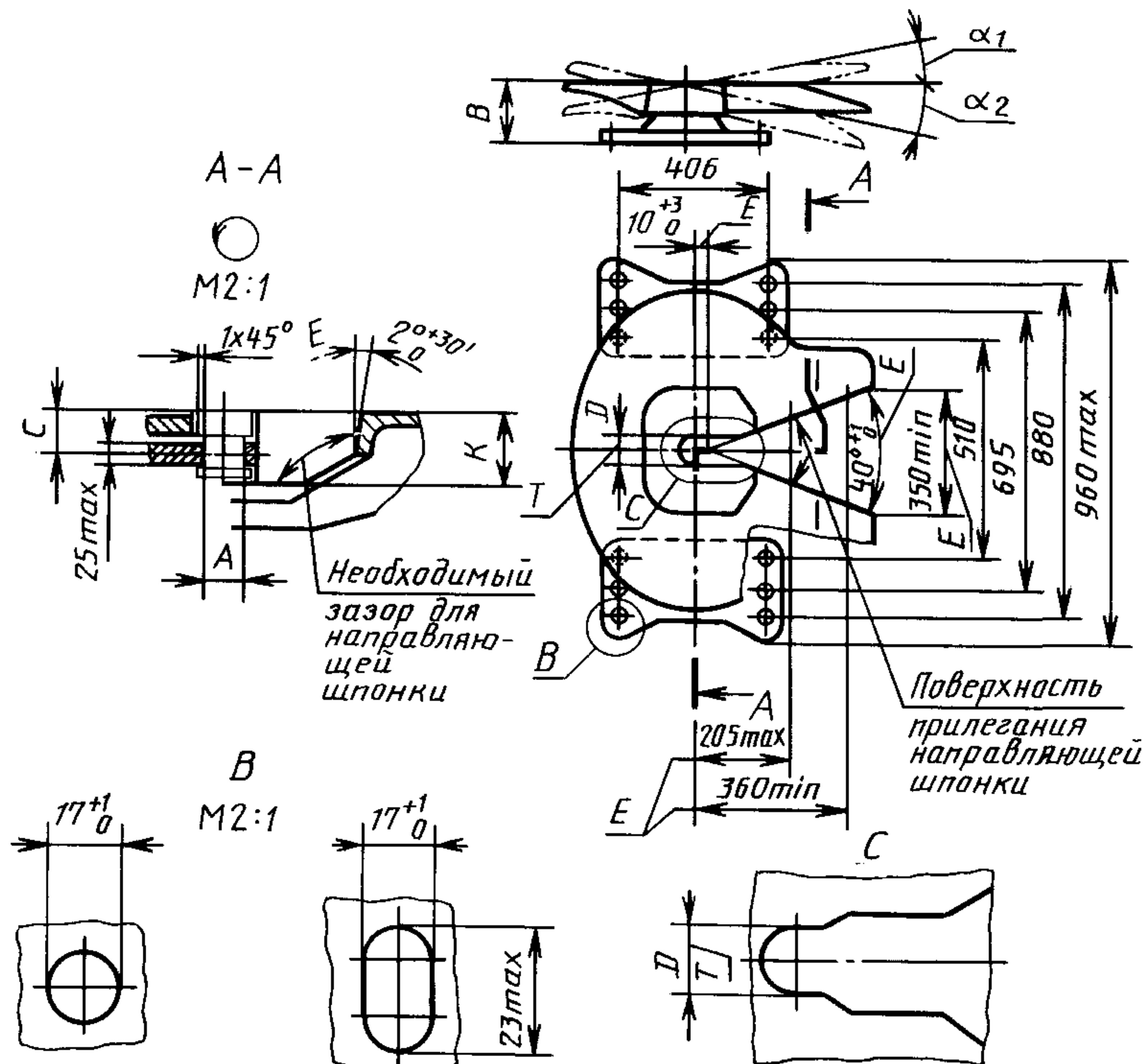
П р и м е ч а н и е.  $E$  — рекомендуемые размеры;  $T$  — размер для двухзахватного седельно-цепного устройства выбирается конструктивно.
