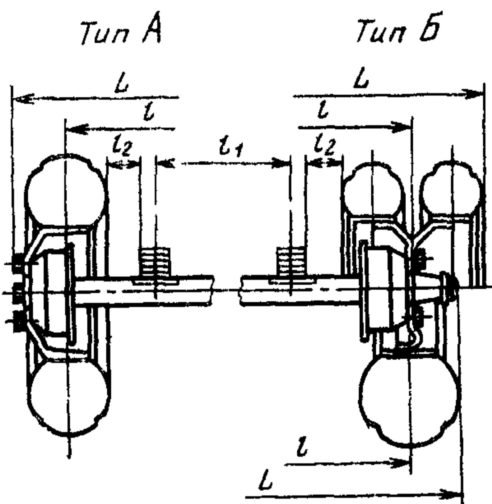
$L$ —габаритная ширина,  $l$ —колея колес,
