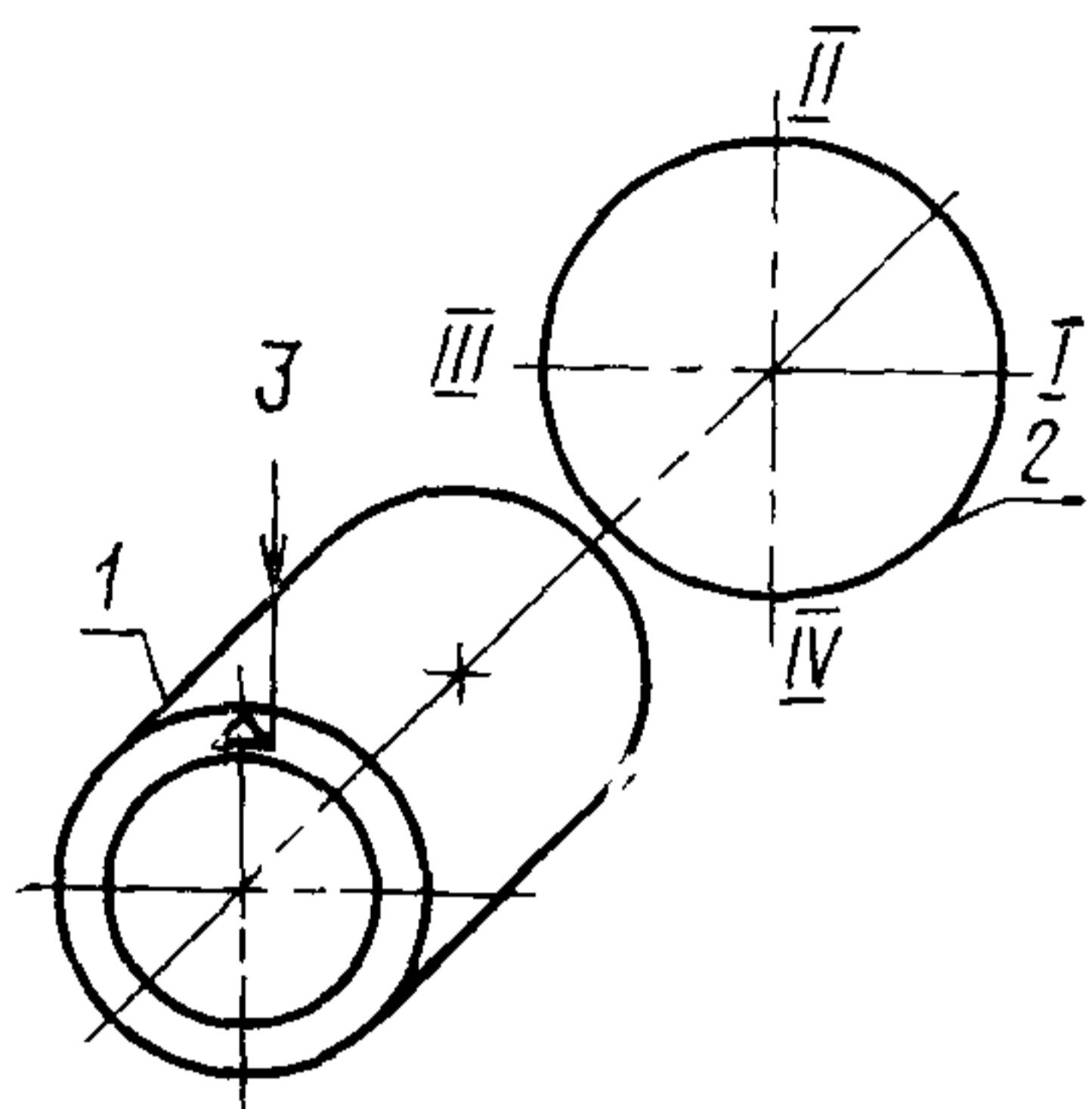
1—испытуемый объектив; 2—фокальная плоскость испытуемого объектива; 3—ориентир
