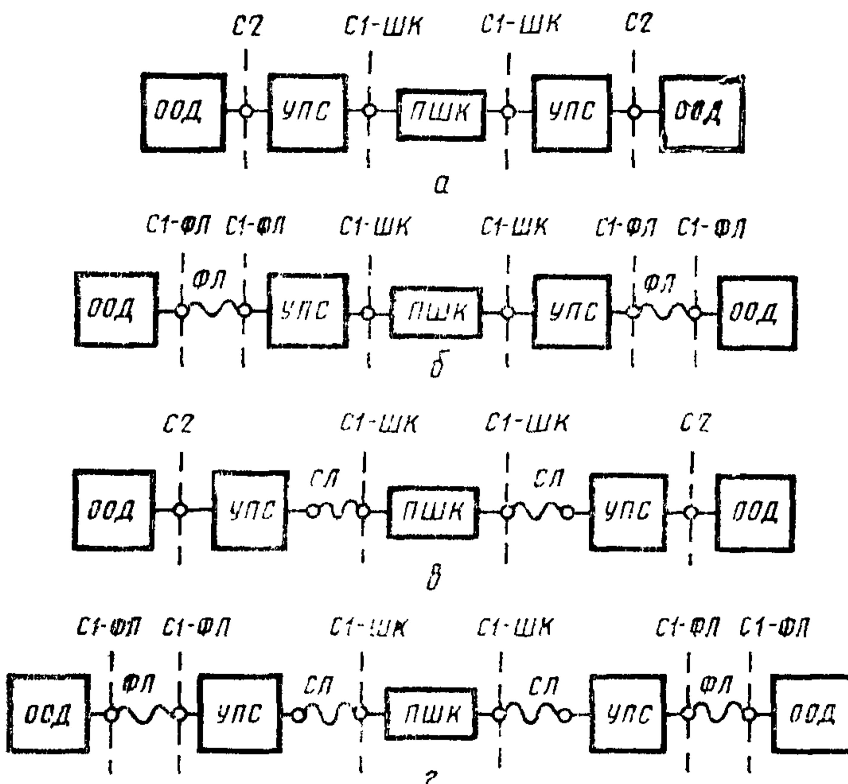
а—УПС сопрягается с *ООД* по цепям стыка *C2* и с *ПШК* по цепям стыка *C1* (*C1-ШК*) при непосредственном сопряжении УПС с *ПШК*; б—УПС сопрягается с *ООД* по цепям стыка *C1-ФЛ* при удалении от *ООД* и с *ПШК* по цепям стыка *C1-ШК*; в—УПС сопрягается с *ООД* по цепям стыка *C2* и с *ПШК* с помощью *СЛ*; г—УПС сопрягается с *ООД* по стыку *C1-ФЛ* и с *ПШК* с помощью *СЛ*.
