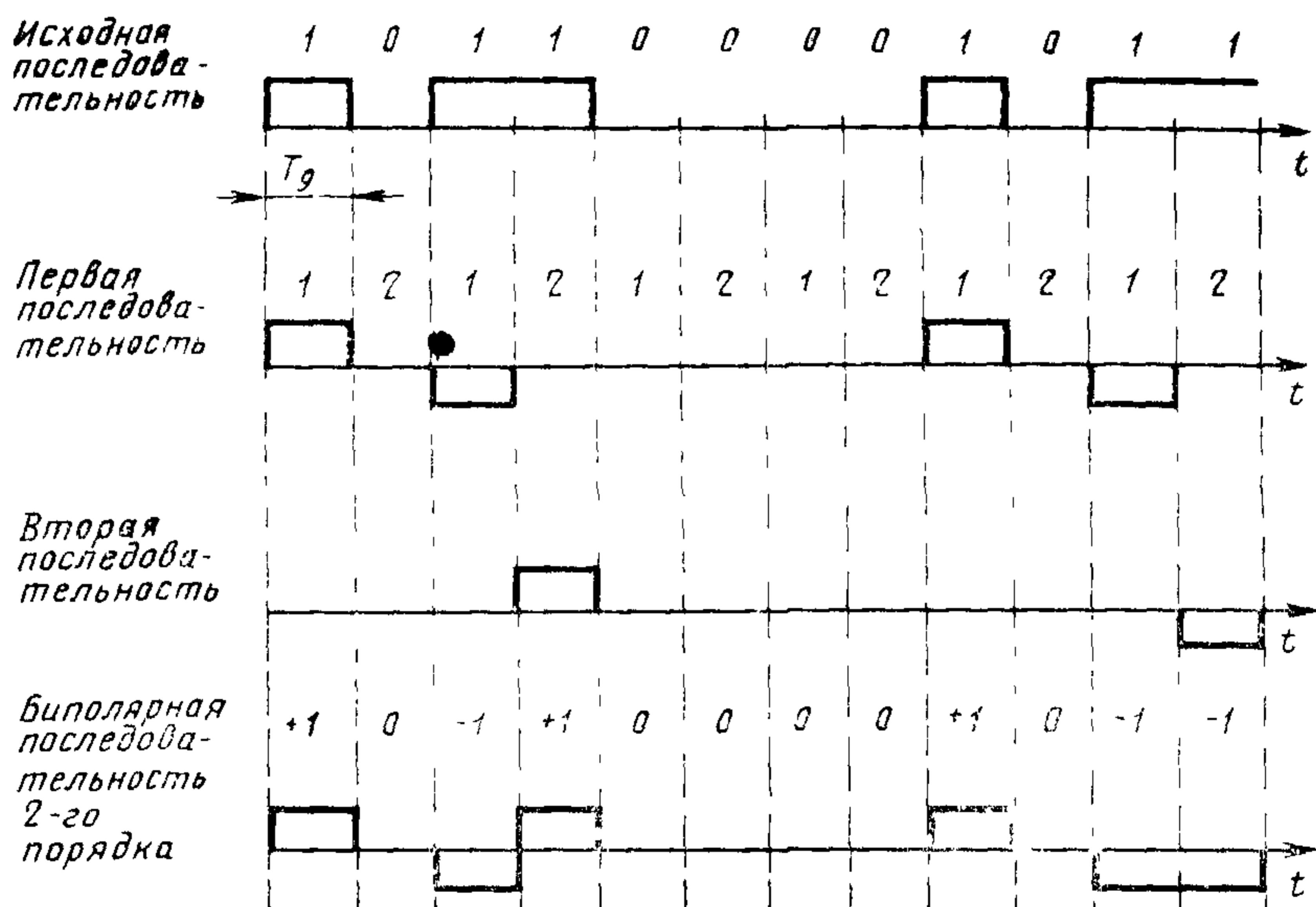
$$T_g = 2T_0, \text{ где } T_0 \text{ — единичный интервал}$$
