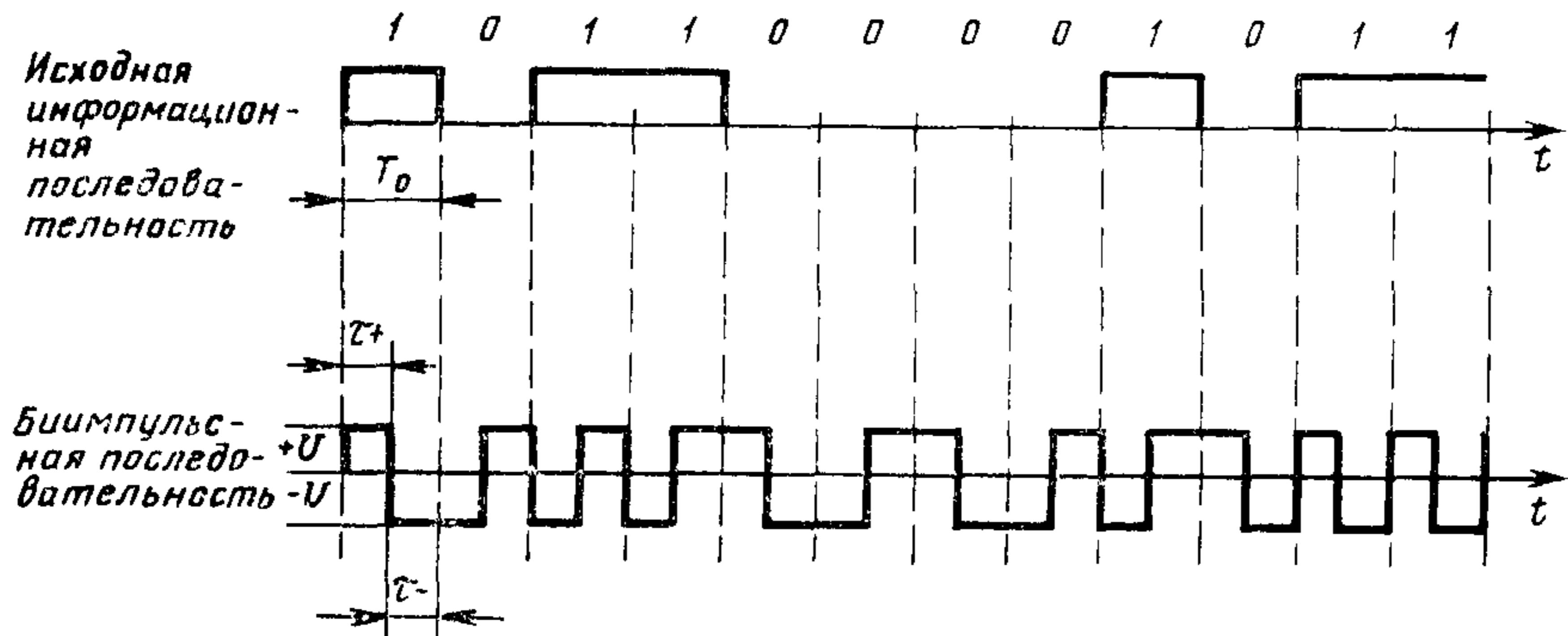
$t_+$  — длительность положительного импульса бимпульса;  $t_-$  — длительность отрицательного импульса бимпульса;  $t_+ + t_- = T_0 / 2$ , где  $T_0$  — единичный интервал;
