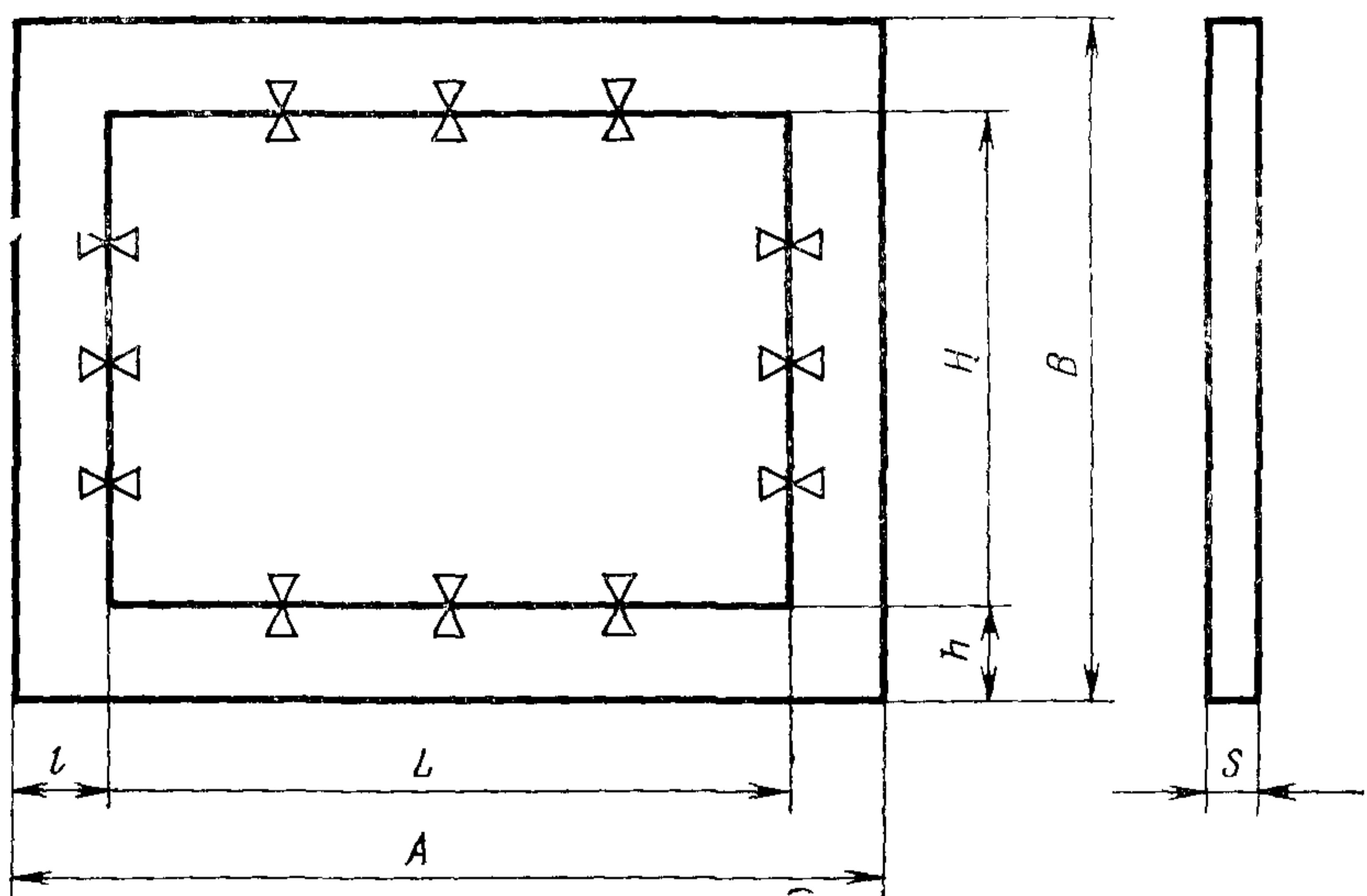
$H$ —высота рабочего поля;  $L$ —ширина рабочего поля,  $A$ —габаритный размер таблицы по горизонтали,  $B$ —габаритный размер таблицы по вертикали,  $h$ —расстояние от границы рабочего поля до края таблицы по вертикали,  $t$ —расстояние от границы рабочего поля до края таблицы по горизонтали,  $s$ —толщина таблицы
