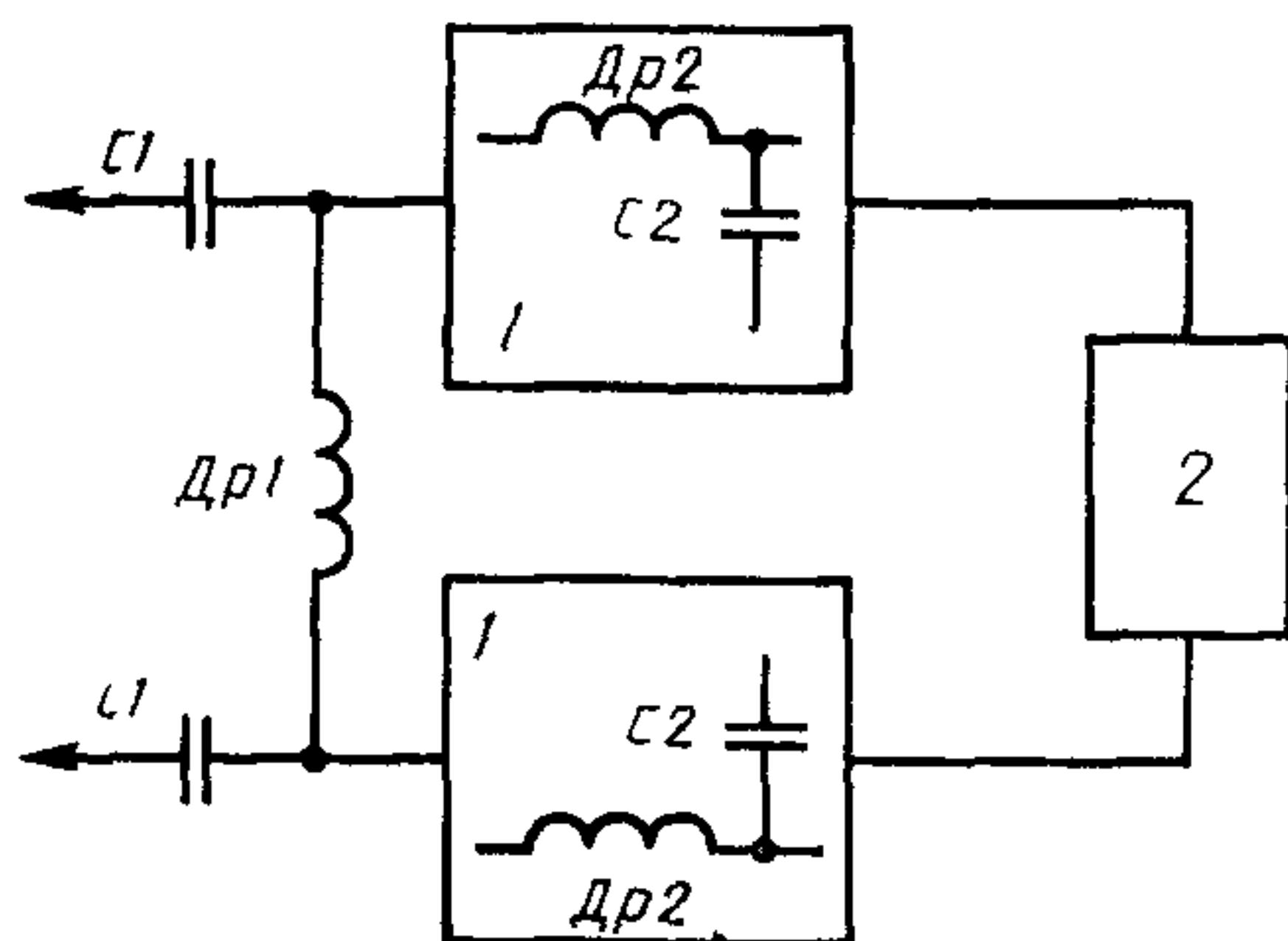
1 — разделятельные схемы 2 — источник тока  $Dr1$  — измеряемый дроссель индуктивностью  $L_i$   $C1$  — защитный конденсатор емкостью не менее 100 мкФ  $Dr2$  — дроссель разделятельной схемы индуктивностью не менее  $6 L_i$   $C2$  — конденсатор разделяльной схемы емкостью не менее 10 мкФ
