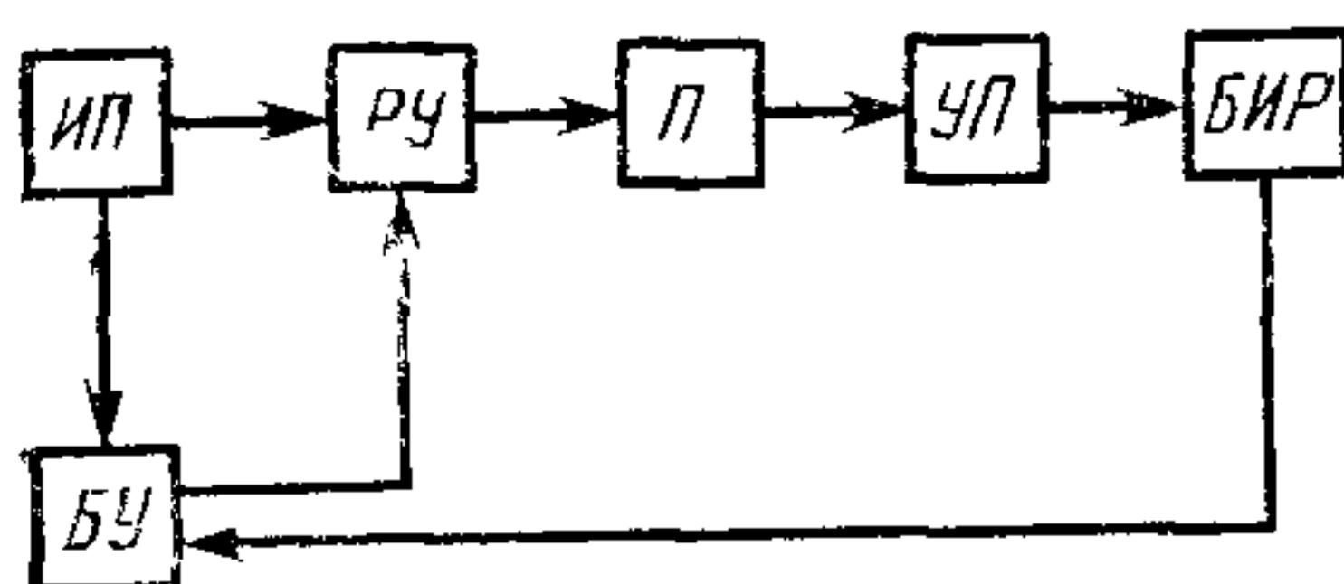
ИП—источник питания; РУ—регулирующее устройство, осуществляющее установку испытательного напряжения; П—преобразователь (высоковольтный трансформатор); УП—устройство для подключения испытуемого объекта; БИР—блок индикации и регистрации; БУ—блок управления.
