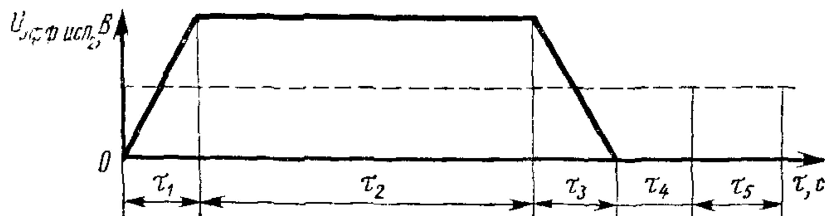
— — — переменное напряжение; — — — постоянное напряжение;  $\tau_1$  — время подачи переменного напряжения 0,2—0,5 с;  $\tau_2$  — время выдержки под суммарным испытательным напряжением  $(5 \pm 2)$  с;  $\tau_3$  — время снятия переменного напряжения 0,2—0,5 с;  $\tau_4$  — время выдержки под напряжением постоянного тока до момента контроля сопротивления изоляции  $(2 \pm 0,2)$  с;  $\tau_5$  — время контроля сопротивления изоляционного промежутка.
