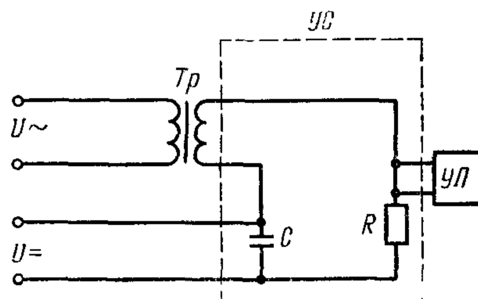
$U \sim$ —источник переменного напряжения;  $U =$ —источник постоянного напряжения;  $T_p$ —высоковольтный трансформатор;  $R$ —ограничительный резистор;  $C$ —разделительная емкость, 1—5 мкФ; *УС*—устройство совмещения постоянной и переменной составляющих; *УП*—устройство для подключения испытуемого объекта
