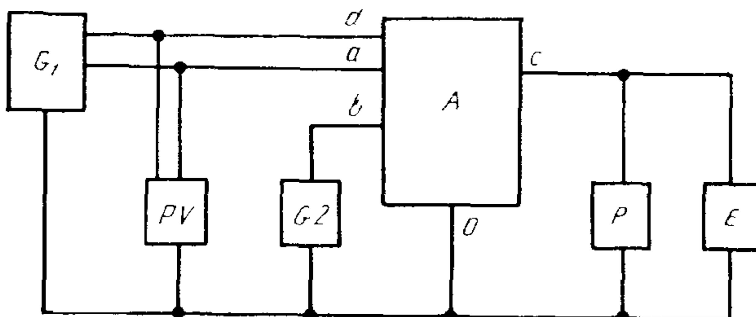
$G_1$  — источник постоянного напряжения,  $PV$  — измеритель по постоянному напряжению;  $G_2$  — генератор гармонического сигнала;  $A$  — схема управления импульсным стабилизатором напряжения,  $a$  — вход коммутируемого напряжения,  $d$  — ввод «питания» микросхемы;  $b$  — вход гармонического сигнала,  $c$  — выход;  $o$  — общий вывод;  $P$  — измеритель времени нарастания и времени спада,  $E$  — нагрузка
