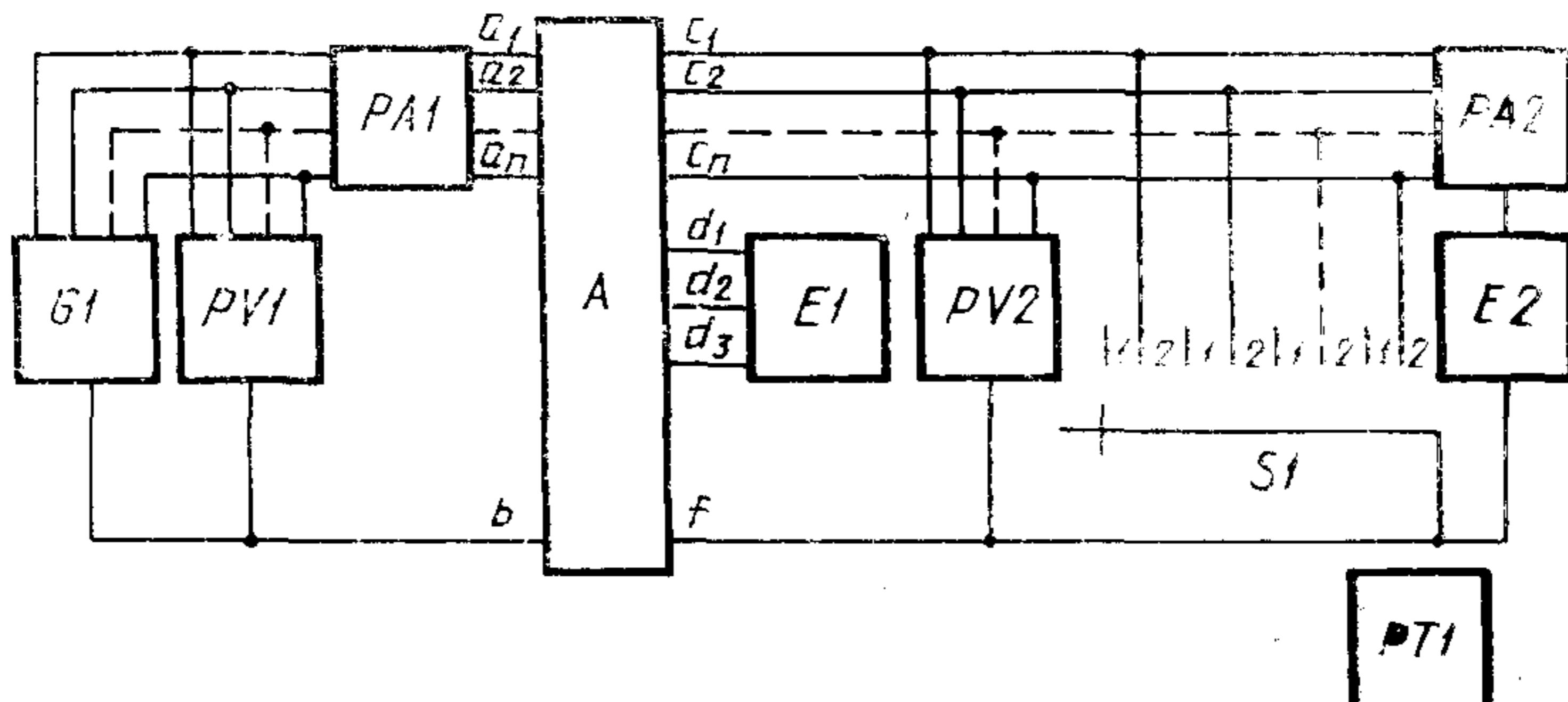
$G_1$  — источник постоянных напряжений;  $PV_1$ ,  $PV_2$  — измерители постоянного напряжения;  $PA_1$ ,  $PA_2$  — измерители постоянного тока;  $A$  — непрерывный стабилизатор напряжения (НСН);  $a_1$ ,  $a_2$ , ...,  $a_n$ ,  $b$  — входы НСН;  $c_1$ ,  $c_2$ , ...,  $c_n$ ,  $f$  — выходы НСН;  $d_1$ ,  $d_2$ ,  $d_3$  — выводы подключения обратной связи;  $E_1$  — блок делителей;  $E_2$  — блок нагрузок НСН;  $S_1$  — переключатель нагрузки;  $PT_1$  — измеритель времени
