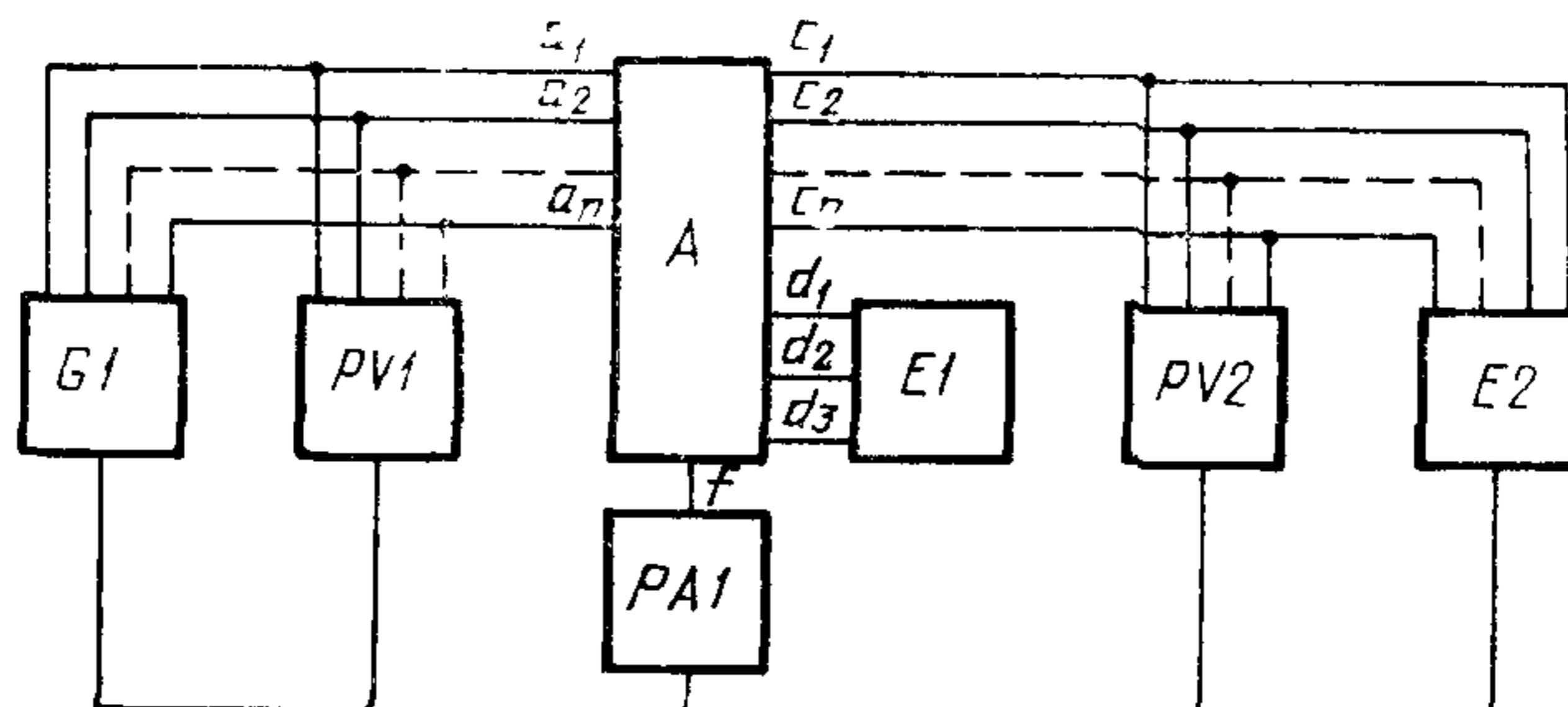
*G<sub>1</sub>* — источник постоянного напряжения; *PV<sub>1</sub>*, *PV<sub>2</sub>* — измерители постоянного напряжения; *A* — НСН, *a<sub>1</sub>*, *a<sub>2</sub>*, ..., *a<sub>n</sub>* — входы НСН; *c<sub>1</sub>*, *c<sub>2</sub>*, ..., *c<sub>n</sub>* — выходы НСН; *d<sub>1</sub>*, *d<sub>2</sub>*, *d<sub>3</sub>* — выводы подключения обратной связи; *f* — общий вывод; *PA<sub>1</sub>* — измеритель постоянного тока; *E<sub>1</sub>* — блок делителей; *E<sub>2</sub>* — блок нагрузок НСН
