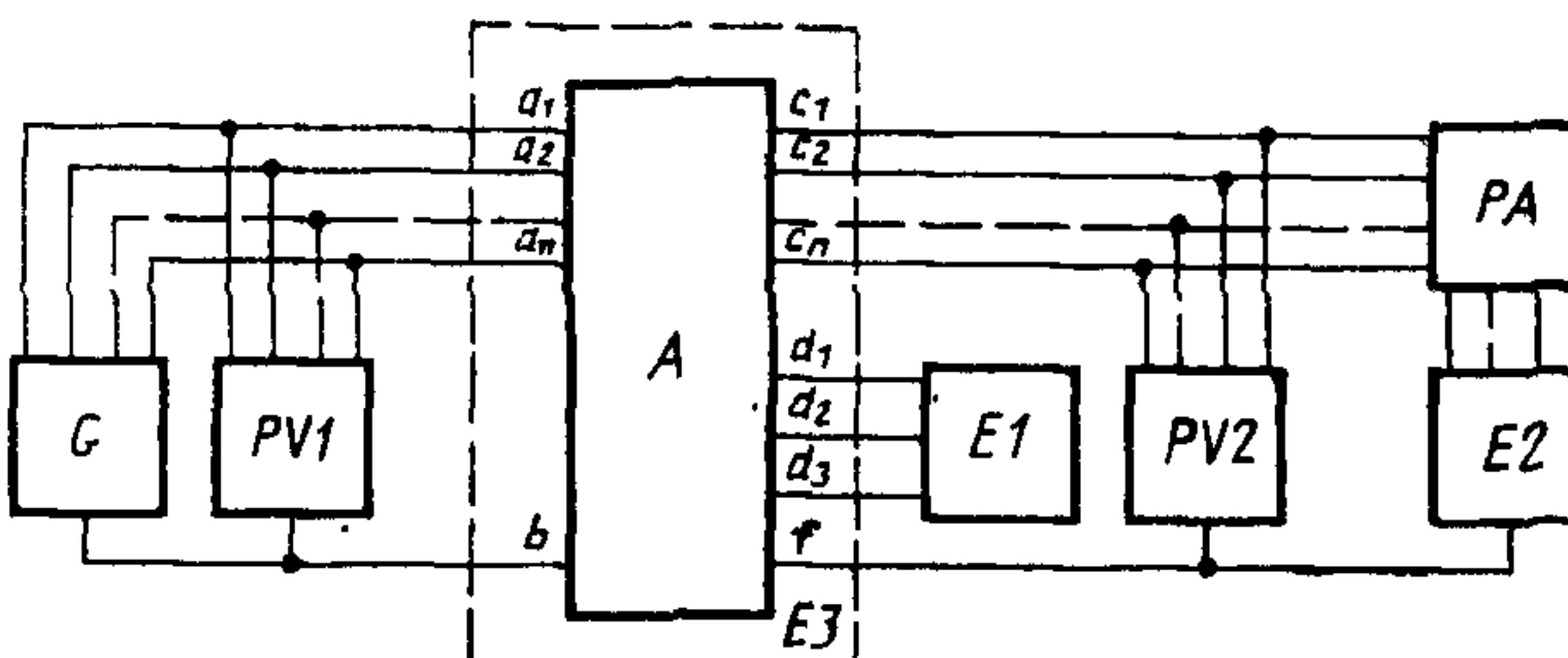
$G$ —источник постоянного напряжения;  $PV1$ —измеритель постоянного напряжения;  $A$ —HSCN;  $a_1, a_2, \dots, a_n$ ,  $b$ —входы HSCN;  $c_1, c_2, \dots, c_n$ ,  $f$ —выходы HSCN;  $d_1, d_2, d_3$ —выводы подключения обратной связи;  $E1$ —блок делителей;  $PV2$ —измеритель постоянного напряжения;  $PA$ —измеритель постоянного тока;  $E2$ —блок нагрузок HSCN;  $E3$ —устройство задания температурного режима
