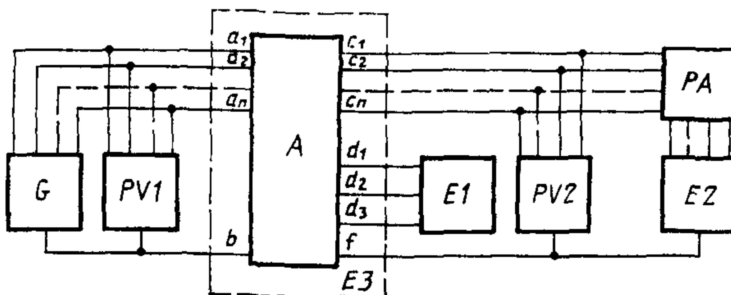
*G*—источник постоянного напряжения; *PV1*—измеритель постоянного напряжения; *A*—НСН; *a<sub>1</sub>*, *a<sub>2</sub>*, ..., *a<sub>n</sub>*, *b*—входы НСН; *c<sub>1</sub>*, *c<sub>2</sub>*, ..., *c<sub>n</sub>*, *f*—выходы НСН; *E1*—блок делителей; *PV2*—измеритель постоянного напряжения; *PA*—измеритель постоянного тока; *E2*—блок нагрузок НСН; *E3*—устройство задания температурного режима; *d<sub>1</sub>*, *d<sub>2</sub>*, *d<sub>3</sub>*—выводы подключения обратной связи
