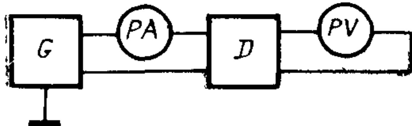
*G* — регулируемый источник постоянного напряжения,
