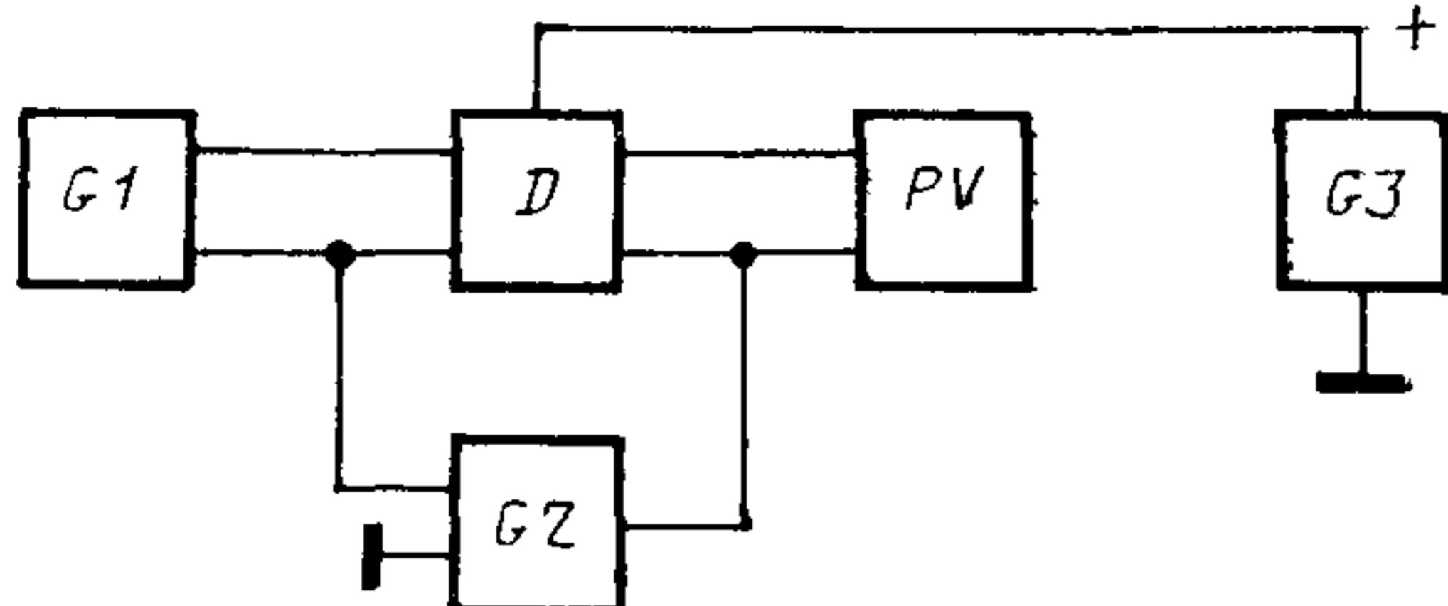
$G_1$  — генератор входного сигнала,  $D$  — проверяемый прибор,  $G_2$  — генератор импульсного напряжения,  $PV$  — измеритель выходного сигнала  $G_3$  — источник постоянного напряжения
