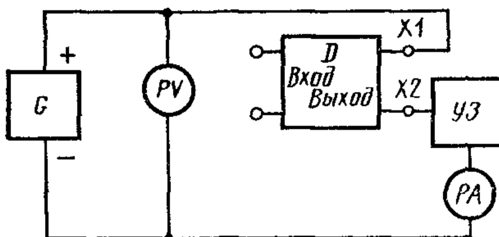
*G*—генератор постоянного тока; *PV*—измеритель напряжения; *D*—измеряемый прибор; *X<sub>1</sub>*, *X<sub>2</sub>*—контакты подключения измеряемого прибора; *УЗ*—устройство защиты измеряемого прибора от перегрузки при коротком замыкании; *PA*—измеритель тока
