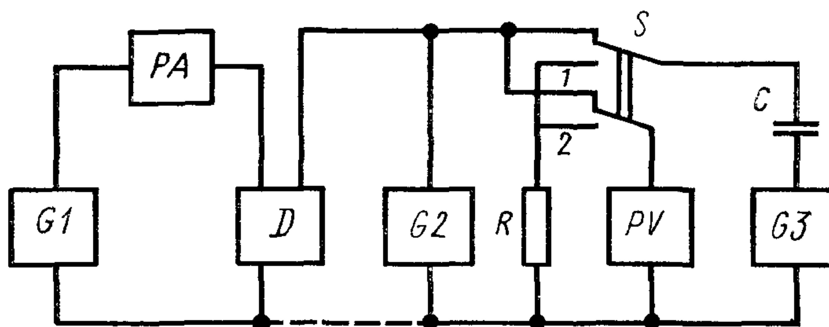
*G<sub>1</sub>*—генератор постоянного прямого тока; *PA*—измеритель постоянного тока; *PV*—измеритель напряжения; *G<sub>2</sub>*—генератор постоянного тока смещения, *G<sub>3</sub>*—генератор переменного тока; *R*—эталонный резистор; *C*—развязывающий конденсатор; *S*—переключатель; *D*—коммутатор
