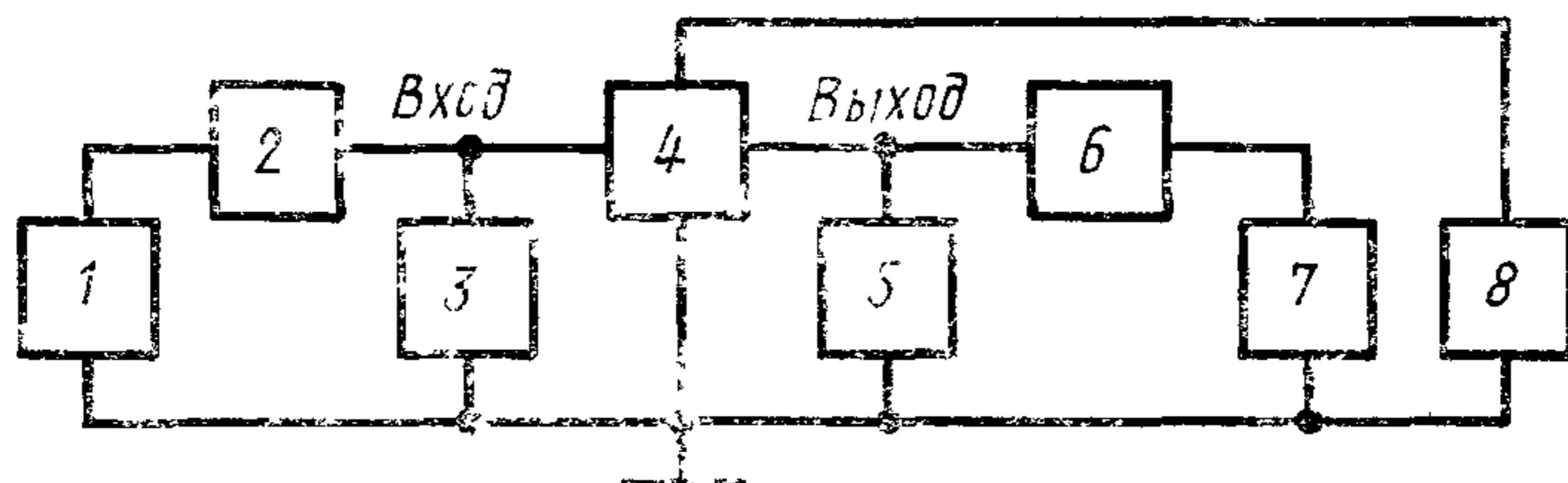
1—генератор постоянного напряжения (тока); 2, 6—измерители постоянного тока; 3, 5—измерители постоянного напряжения; 4—переключатель; 7—генератор постоянного тока; 8—блок питания.
