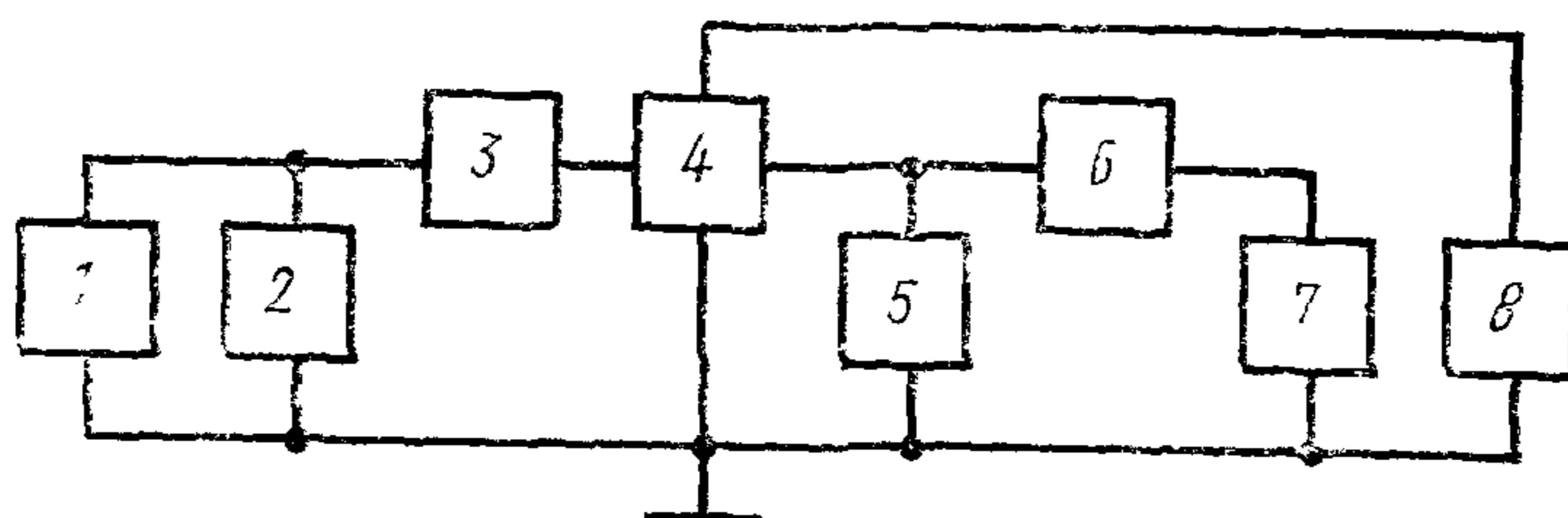
1—генератор постоянного напряжения; 2, 5—измерители напряжения; 3, 6—измерители тока; 4—переключатель; 7—генератор постоянного тока; 8—блок питания.
