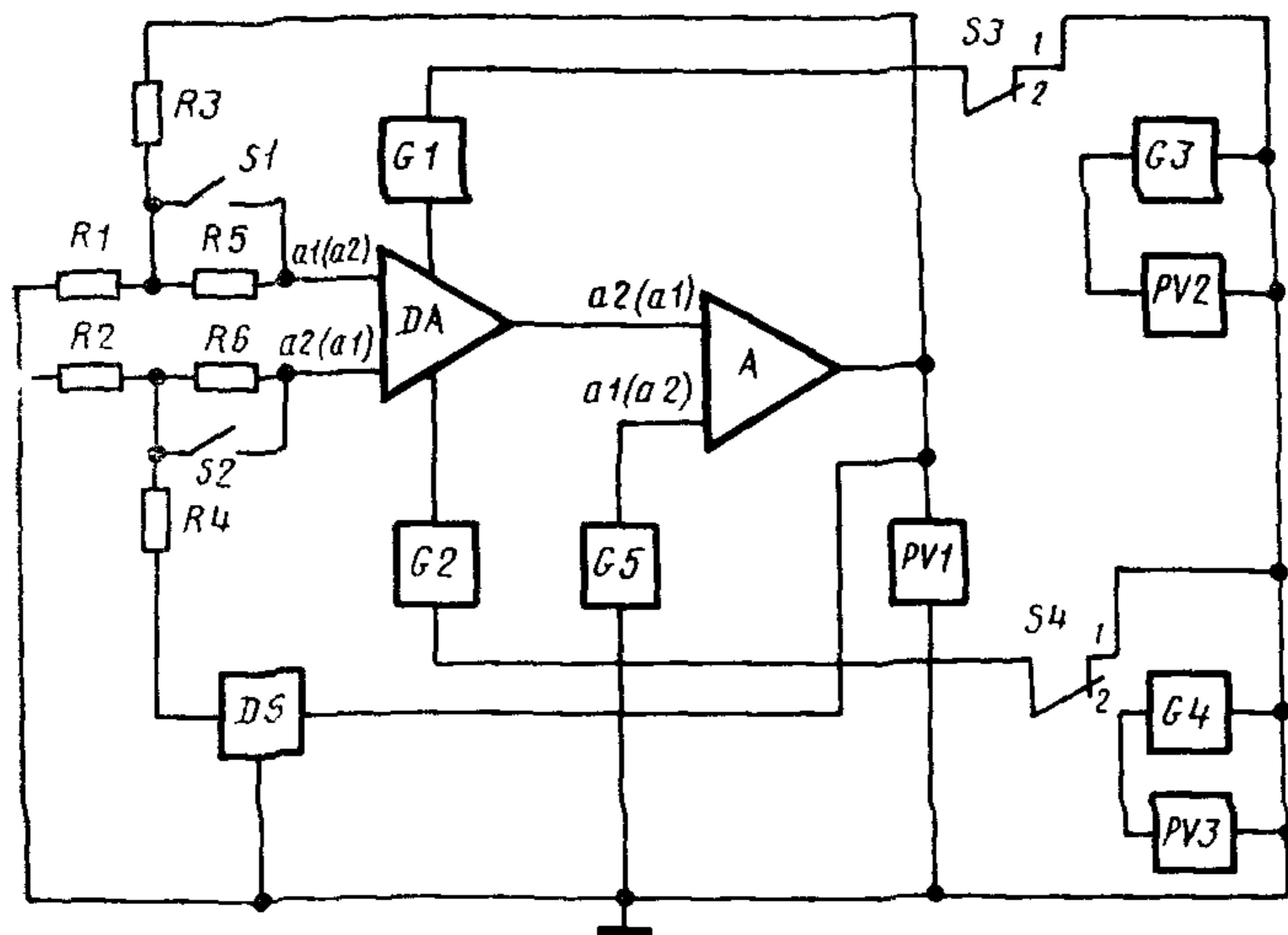
DA — проверяемый ОУ; G1, G2, G3, G4, G5 — источники постоянного напряжения, DS — устройство выборки и хранения; PV1, PV2, PV3 — измерители постоянного напряжения, R1, R2, R3, R4, R5, R6 — резисторы измерительной схемы  $a_1$  — инвертирующий вход,  $a_2$  — неинвертирующий вход; S1, S2, S3, S4 — коммутирующие устройства; A — вспомогательное устройство балансировки (ВУБ)
