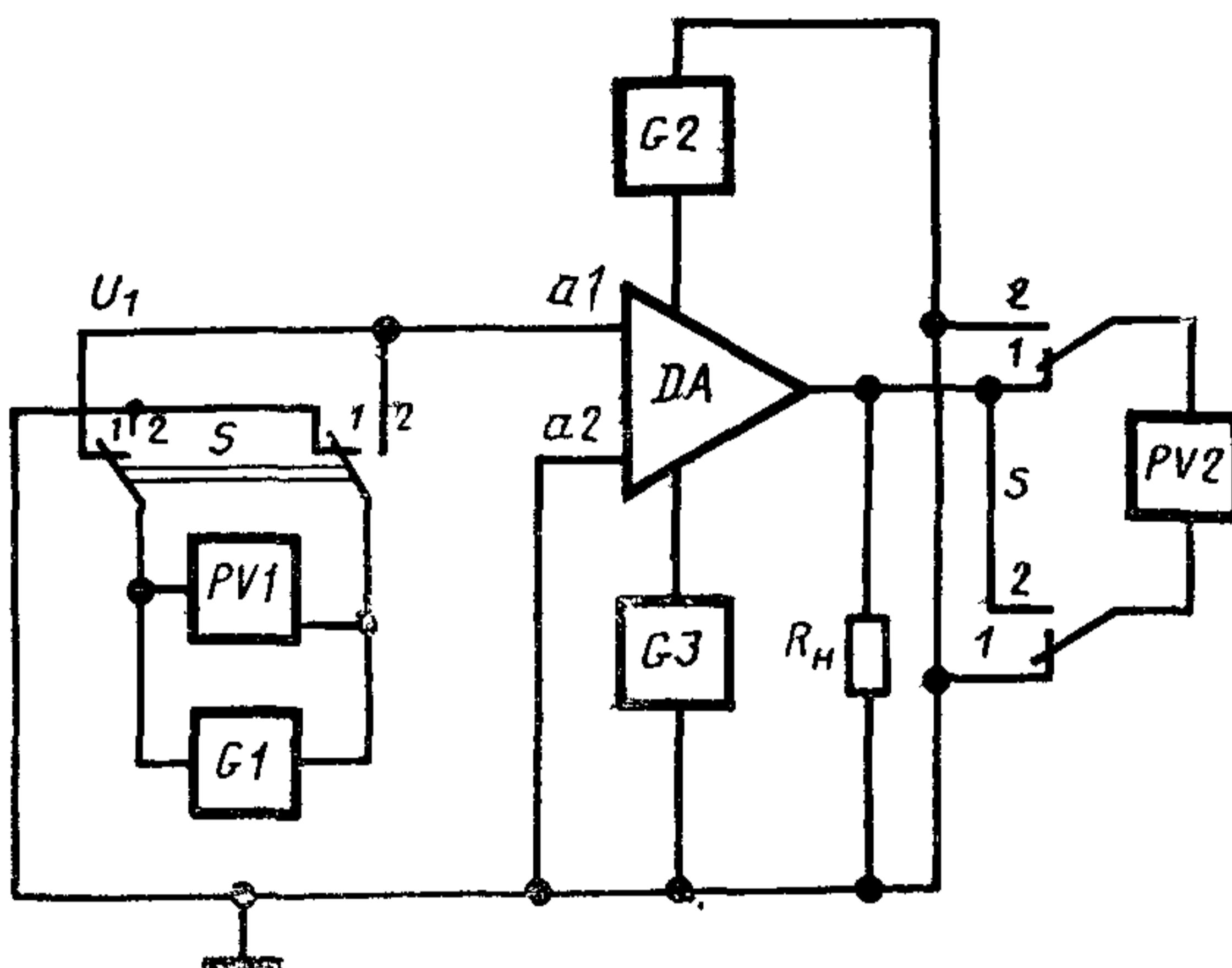
*DA — проверяемый ОУ, G<sub>1</sub>, G<sub>2</sub>, G<sub>3</sub> — источники постоянного напряжения, PV<sub>1</sub>, PV<sub>2</sub> — измерители постоянного напряжения, R<sub>H</sub> — резистор нагрузки
