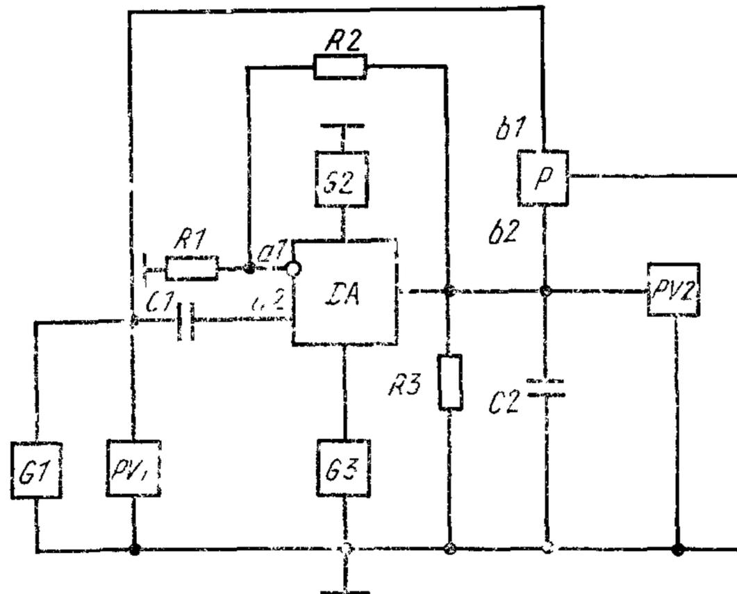
$DA$ —проверяемый ОУ;  $G1$ —источник переменного напряжения,  $G2, G3$ —источники постоянного напряжения;  $PV1, PV2$ —измерители переменного напряжения;  $P$ —измеритель разности фаз,  $R1, R2$ —резисторы делителя напряжения;  $R3$ —резистор нагрузки проверяемого ОУ,  $C1$ —разделительный конденсатор,  $C2$ —конденсатор нагрузки проверяемого ОУ;  $a1$ —инвертирующий вход ОУ;  $a2$ —неинвертирующий вход ОУ,  $b1$ —первый вход измерителя  $P$ ;  $b2$ —второй вход измерителя  $P$
