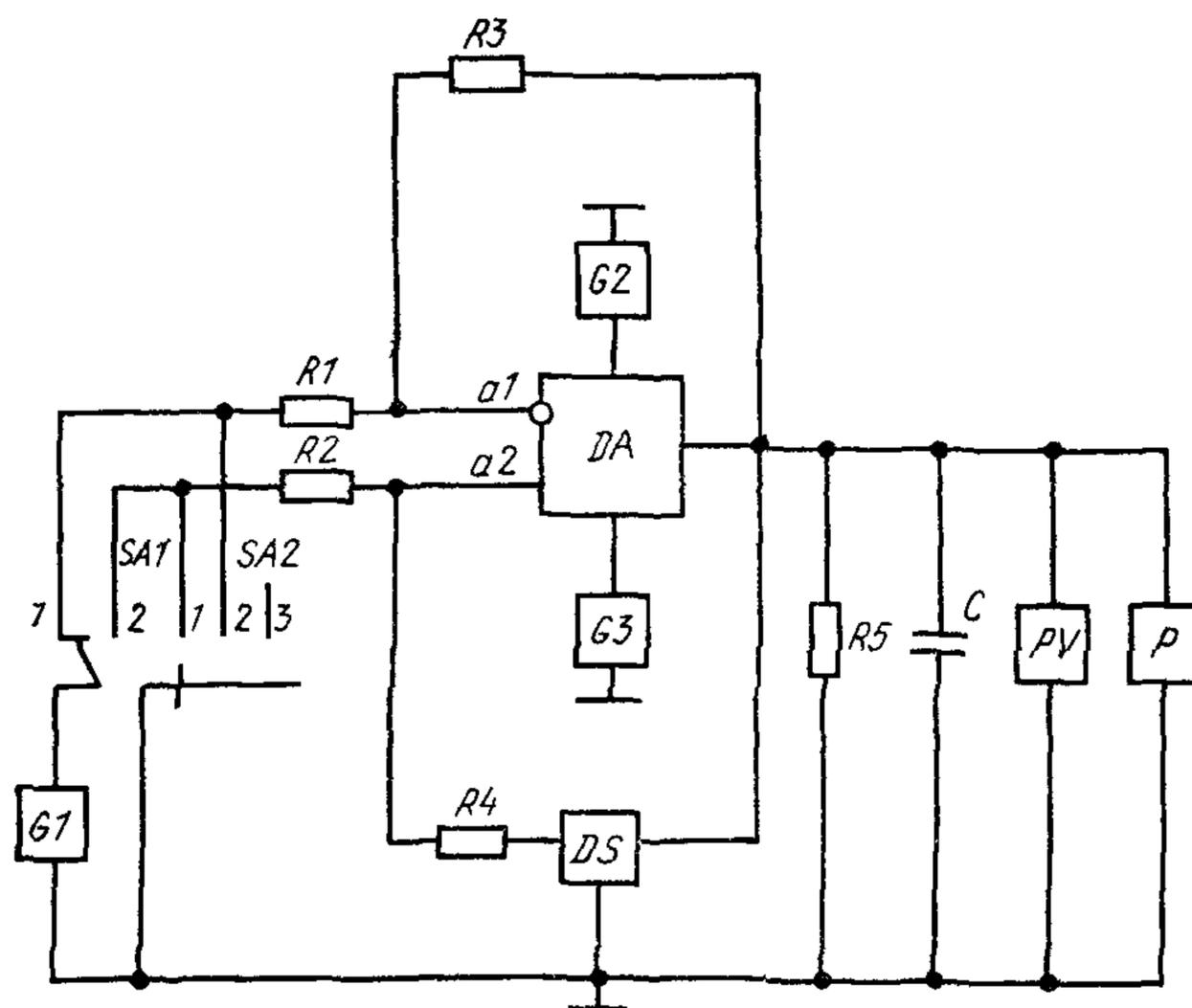
DA—проверяемый ОУ;  $G1$ —источник переменного напряжения;  $G2$ ,  $G3$ —источники постоянного напряжения,  $DS$ —устройство выборки и хранения;  $PV$ —измеритель переменного напряжения;  $P$ —измеритель нелинейных искажений;  $R1—R4$ —резисторы делителей;  $R5$ —резистор нагрузки проверяемого ОУ;  $C$ —конденсатор нагрузки проверяемого ОУ;  $SA1$ ,  $SA2$ —устройства коммутации;  $a1$ —инвертирующий вход;  $a2$ —неинвертирующий вход
