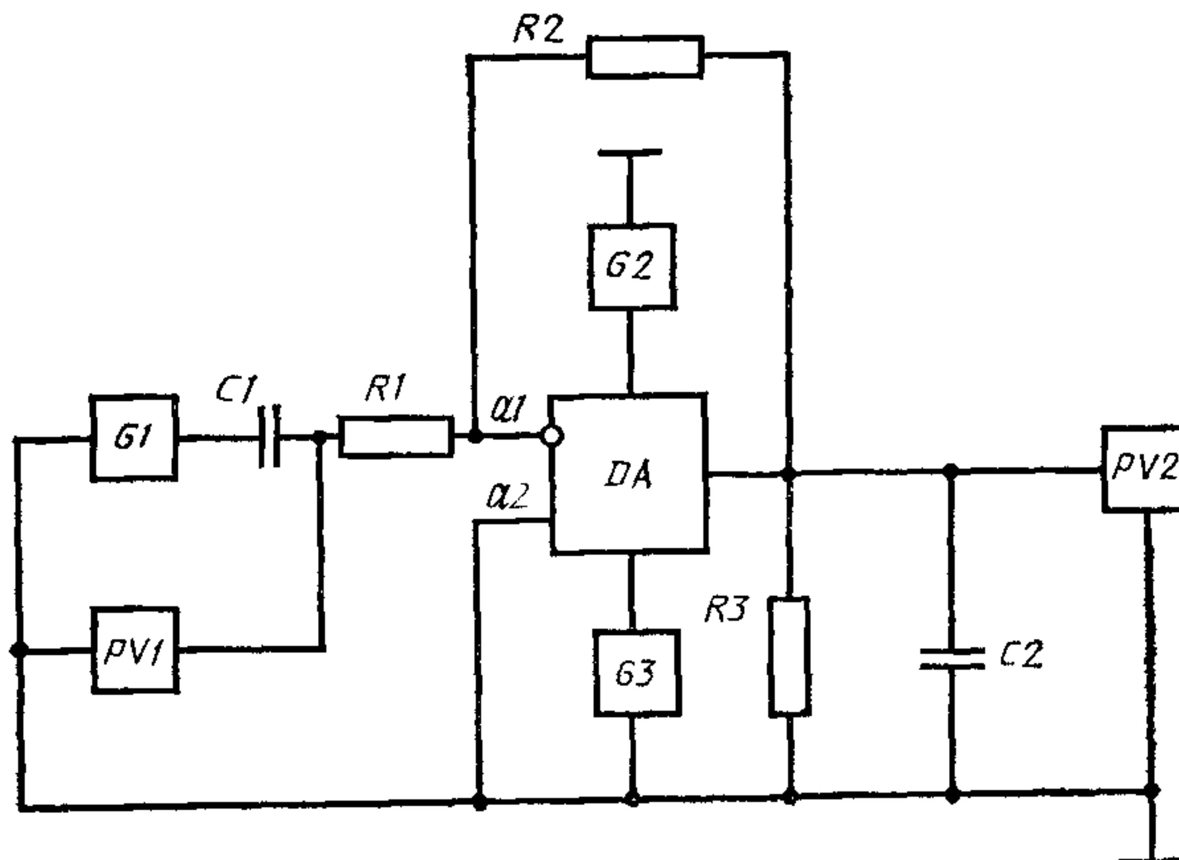
DA — проверяемый ОУ; G1 — источник переменного напряжения; PV1, PV2 — измерители переменного напряжения; R1, R2 — резисторы делителя напряжения; R3 — резистор нагрузки проверяемого ОУ; C1 — разделительный конденсатор, C2 — конденсатор нагрузки проверяемого ОУ; a1 — инвертирующий вход; a2 — неинвертирующий вход.
