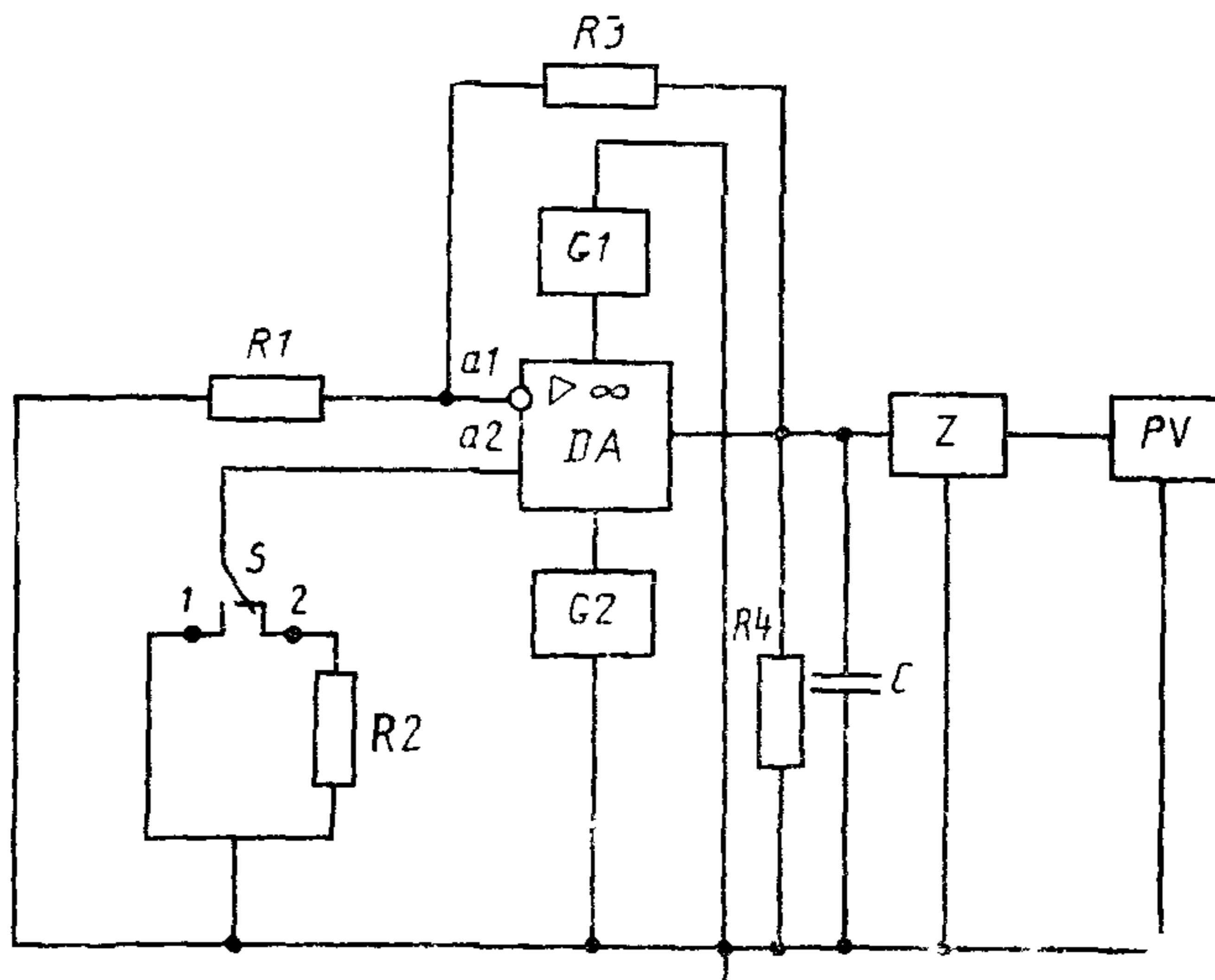
*DA*—проверяемый ОУ, *G<sub>1</sub>*, *G<sub>2</sub>*—источники постоянного напряжения, *Z*—полосовой фильтр, *PV*—измеритель переменного напряжения, *R<sub>1</sub>*, *R<sub>3</sub>*—резисторы обратной связи, *R<sub>2</sub>*—резистор, имитирующий сопротивление источника шума, *R<sub>4</sub>*—резистор нагрузки, *C*—конденсатор нагрузки, *S*—устройство коммутации, *a<sub>1</sub>*—инвертирующий вход ОУ, *a<sub>2</sub>*—неинвертирующий вход ОУ
