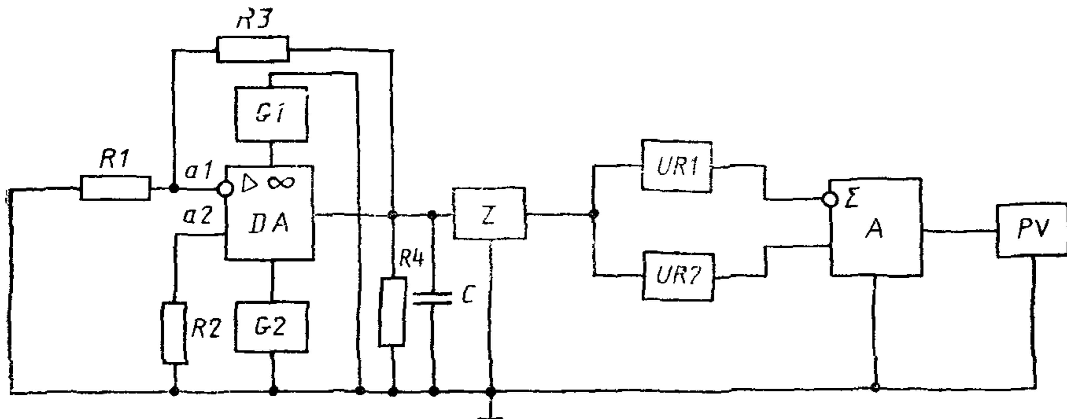
$DA$ —проверяемый ОУ;  $A$ —сумматор;  $G1$ ,  $G2$ —источники постоянного напряжения;  $R1$ ,  $R3$ —резисторы обратной связи;  $R2$ —резистор, имитирующий сопротивление источника шума;  $R4$ —резистор нагрузки;  $C$ —конденсатор нагрузки;  $UR1$ ,  $UR2$ —пиковые детекторы положительной и отрицательной полярности,  $Z$ —полосовой фильтр;  $a1$ —инвертирующий вход ОУ;  $a2$ —неинвертирующий вход ОУ
