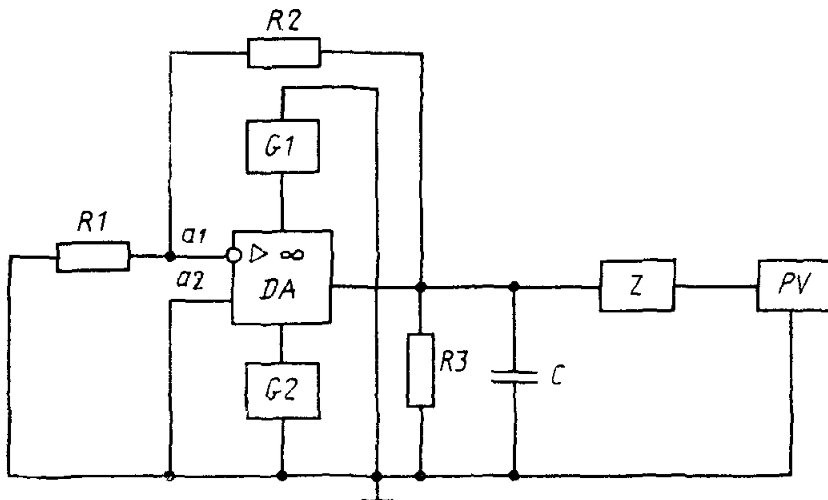
$DA$  — проверяемый ОУ,  $G_1$ ,  $G_2$  — источники постоянного напряжения,  $Z$  — полосовой фильтр,  $PV$  — измеритель эффективного значения переменного напряжения,  $R_1$ ,  $R_2$  — резисторы обратной связи,  $R_3$  — резистор нагрузки,  $C$  — конденсатор нагрузки,  $a_1$  — инвертирующий вход ОУ,  $a_2$  — неинвертирующий вход ОУ
