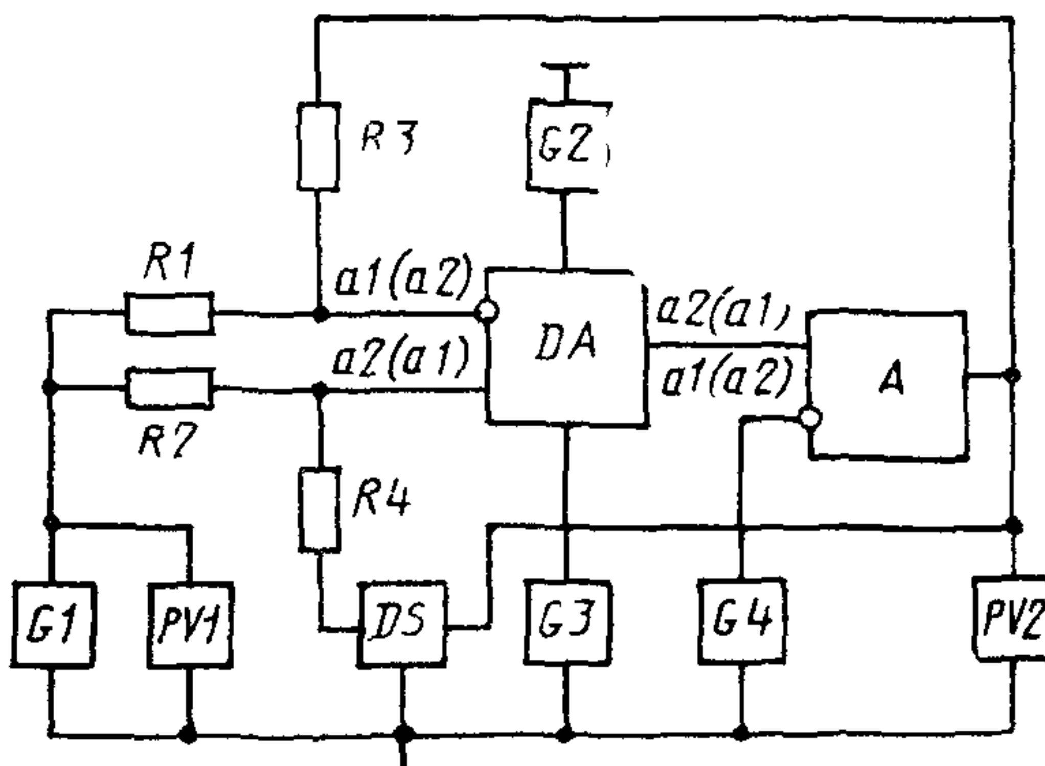
*DA* — проверяемый ОУ или КН; *A* — вспомогательное устройство балансировки; *G<sub>1</sub>*, *G<sub>2</sub>*, *G<sub>3</sub>*, *G<sub>4</sub>* — источники постоянного напряжения; *DS* — устройство выборки и хранения; *PV<sub>1</sub>*, *PV<sub>2</sub>* — измерители постоянного напряжения; *R<sub>1</sub>*, *R<sub>2</sub>*, *R<sub>3</sub>*, *R<sub>4</sub>* — резисторы делителей напряжения; *a<sub>1</sub>* — инвертирующий вход; *a<sub>2</sub>* — неинвертирующий вход
