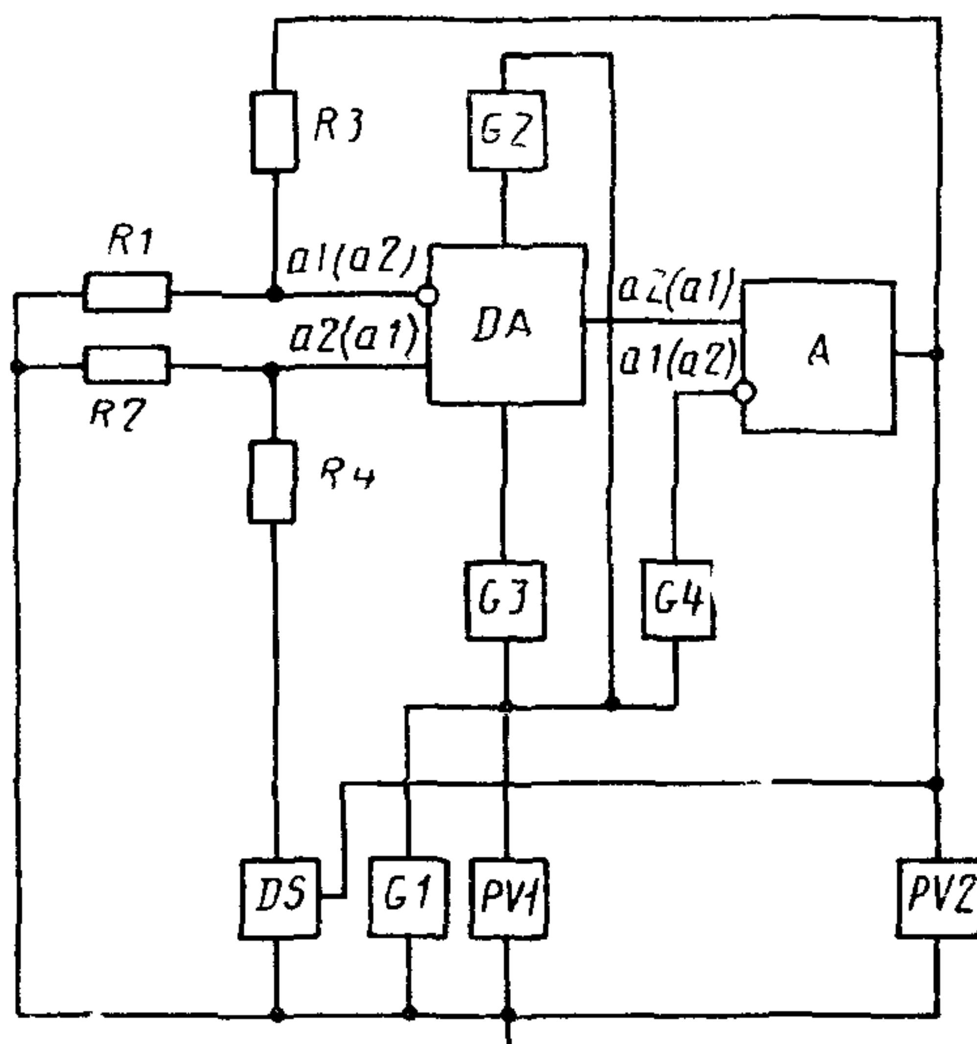
$DA$  — проверяемый ОУ или КН,  $A$  — вспомогательное устройство балансировки,  $G_1, G_2, G_3, G_4$  — источники постоянного напряжения,  $DS$  — устройство выборки и хранения;  $PV_1, PV_2$  — измерители постоянного напряжения,  $R_1, R_2, R_3, R_4$  — резисторы делителей напряжения,  $a_1$  — инвертирующий вход,  $a_2$  — неинвертирующий вход
