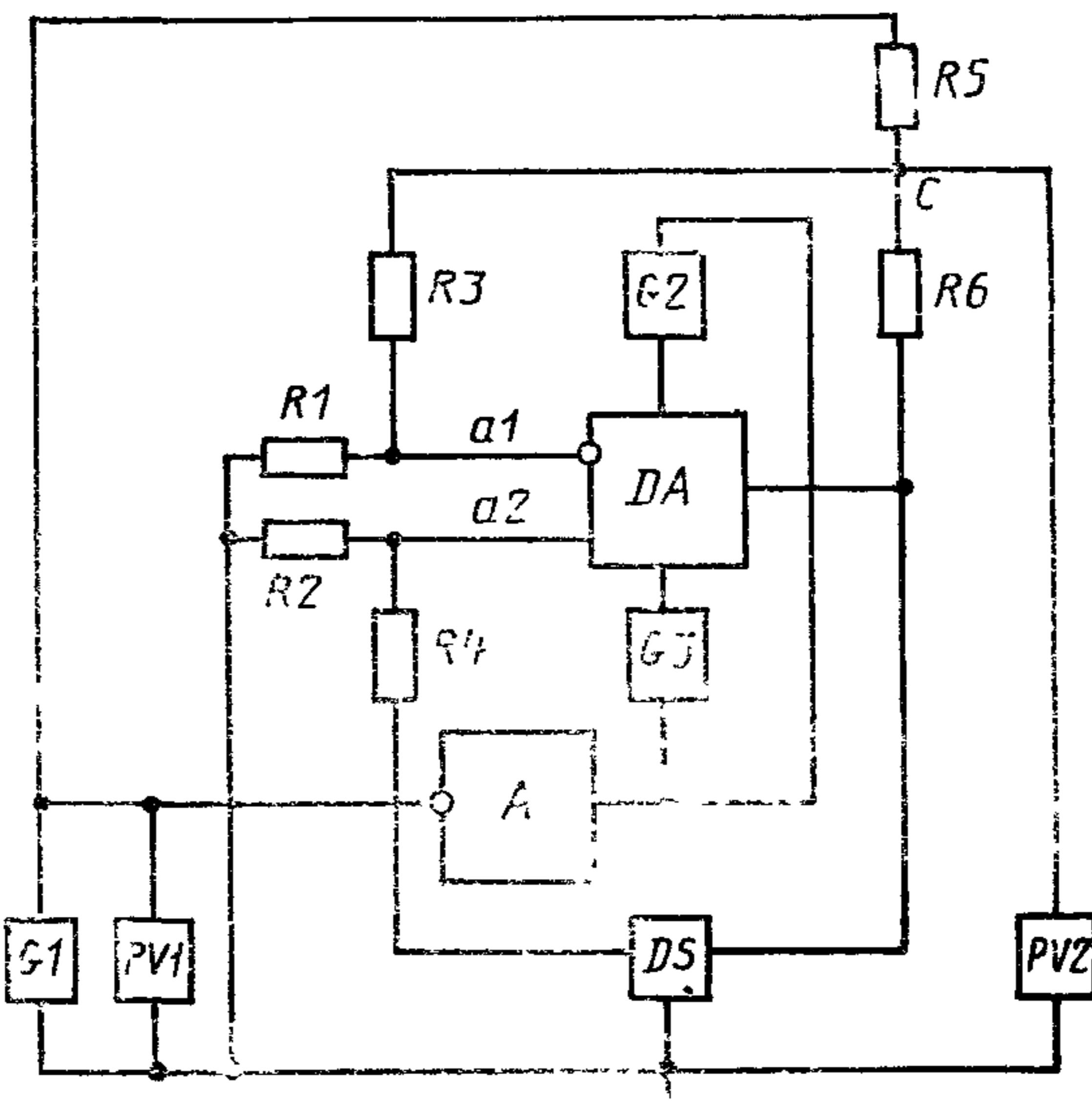
$DA$  — проверяемый ОУ или КН;  $C$  — источник постоянного напряжения;  $DS$  — устройство выборки и хранения;  $PV_1$ ,  $PV_2$  — измерители постоянного напряжения;  $R_5$ ,  $R_6$  — резисторы суммирования;  $R_1$ ,  $R_2$ ,  $R_3$ ,  $R_4$  — резисторы делителей напряжения;  $A$  — усилитель-инвертор;  $a_1$  — инвертирующий вход ОУ или КН,  $a_2$  — неинвертирующий вход ОУ или КН,  $C$  — суммирующая точка
