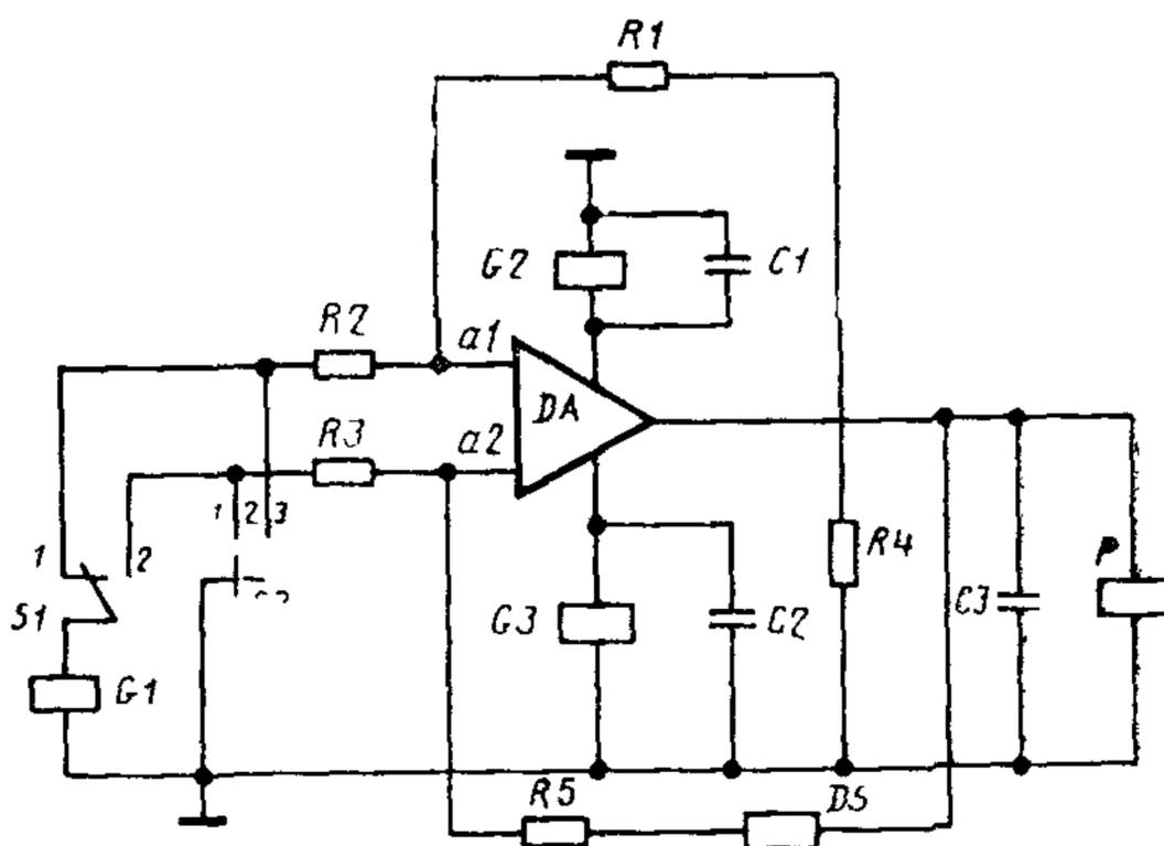
DA — проверяемый ОУ; G1 — генератор прямоугольных импульсов; G2 и G3 — источники постоянного напряжения, P — измеритель; DS — устройство выборки и хранения; R1, R2, R3, R5 — резисторы делителей напряжения; R4 — резистор нагрузки ОУ, C1 и C2 — шунтирующие конденсаторы; C3 — конденсатор нагрузки ОУ, S1 и S2 — устройства коммутации, a1 — инвертирующий вход; a2 — неинвертирующий вход. Элементы цепей коррекции не указаны.
