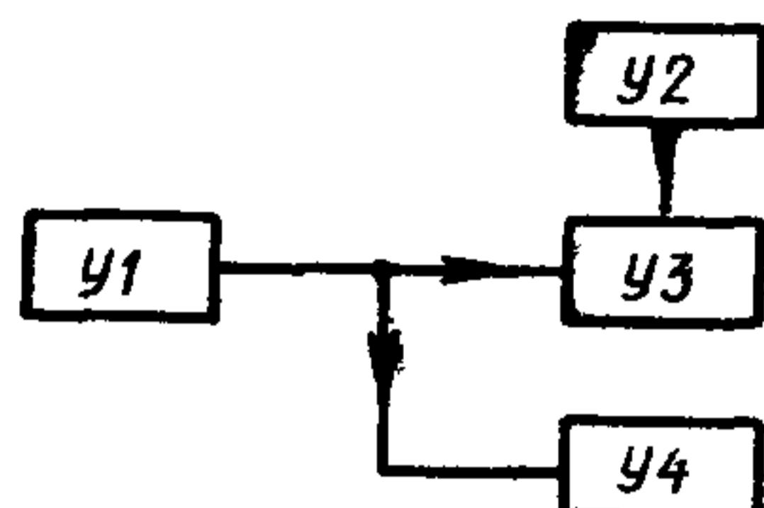
У1—генератор управляющих импульсов; У2—источник постоянного напряжения; У3—схема включения прибора, У4—осциллограф.
