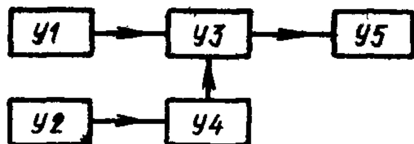
У1—генератор импульсов; У2—источник постоянного напряжения; У3—электронный ключ; У4—прибор; У5—пересчетное устройство.
