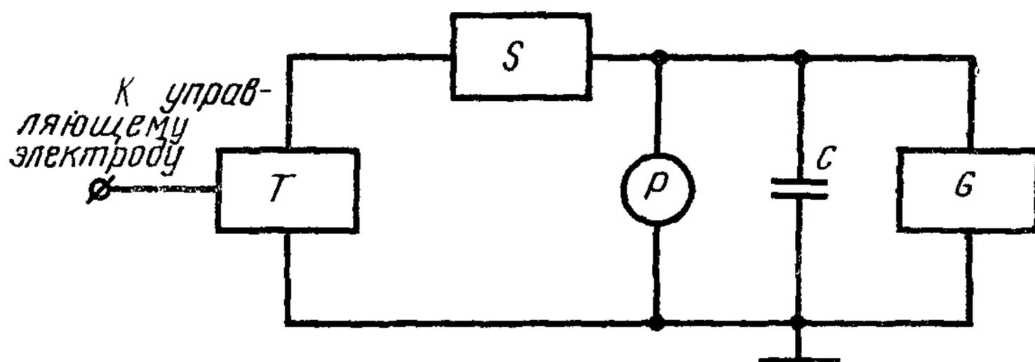
$C$ —накопительный конденсатор;  $P$ —измеритель напряжения;  $T$ —импульсный трансформатор;  $S$  — коммутирующее устройство;  $G$  — источник напряжения
