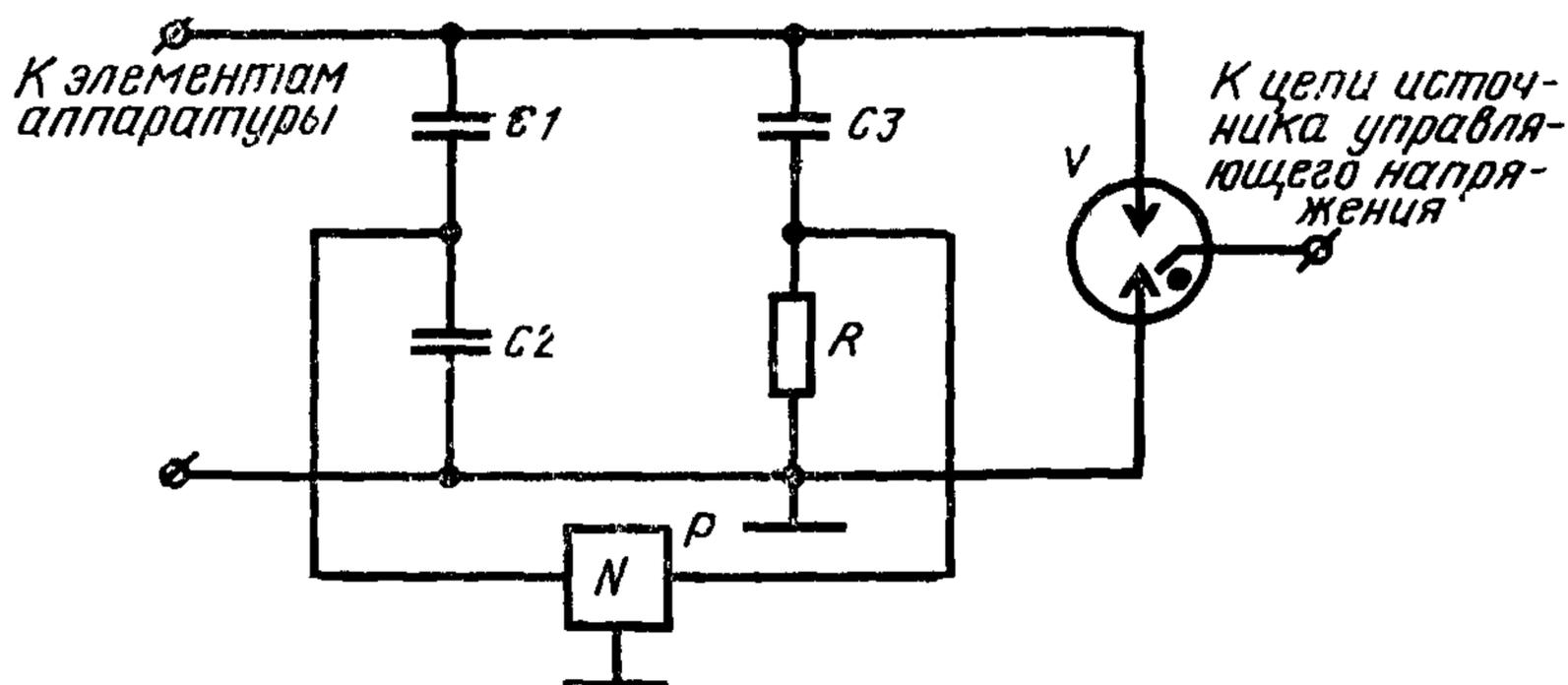
$R$  — измерительный резистор;  $C_1$ ,  $C_2$  — конденсаторы делителя напряжения;  $C_3$  — накопительный конденсатор;  $P$  — осциллограф или частотомер;  $V$  — испытываемый разрядник
