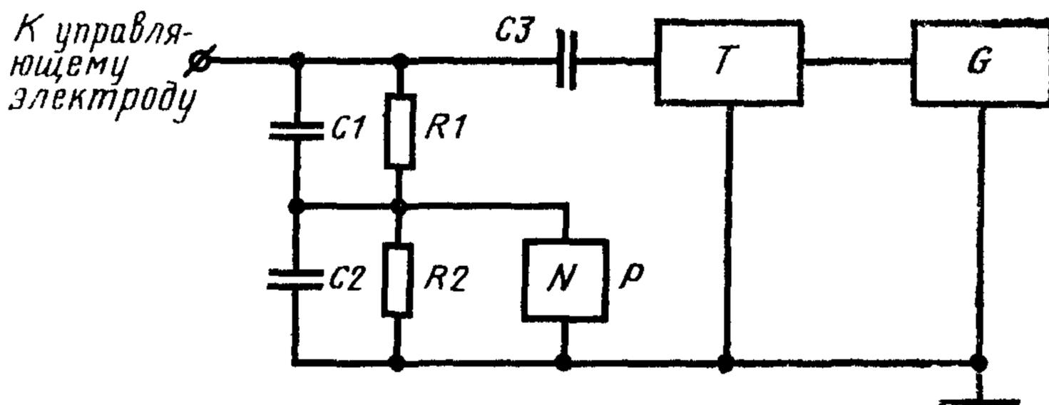
$R_1$   $R_2$  — резисторы делителя  $C_1$ ,  $C_2$  — конденсаторы делителя,  $C$  — раз-
