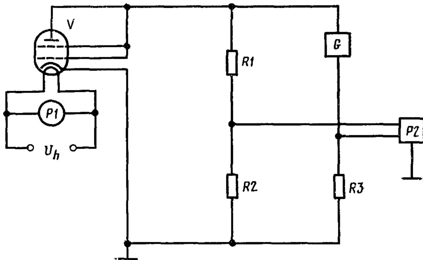
*G*—генератор импульсов; *P1*—прибор для измерения постоянного (переменного) напряжения, *P2*—электронный осциллограф; *R1R2*—делитель напряжения, *R3*—измерительный резистор, *V*—испытываемая лампа
