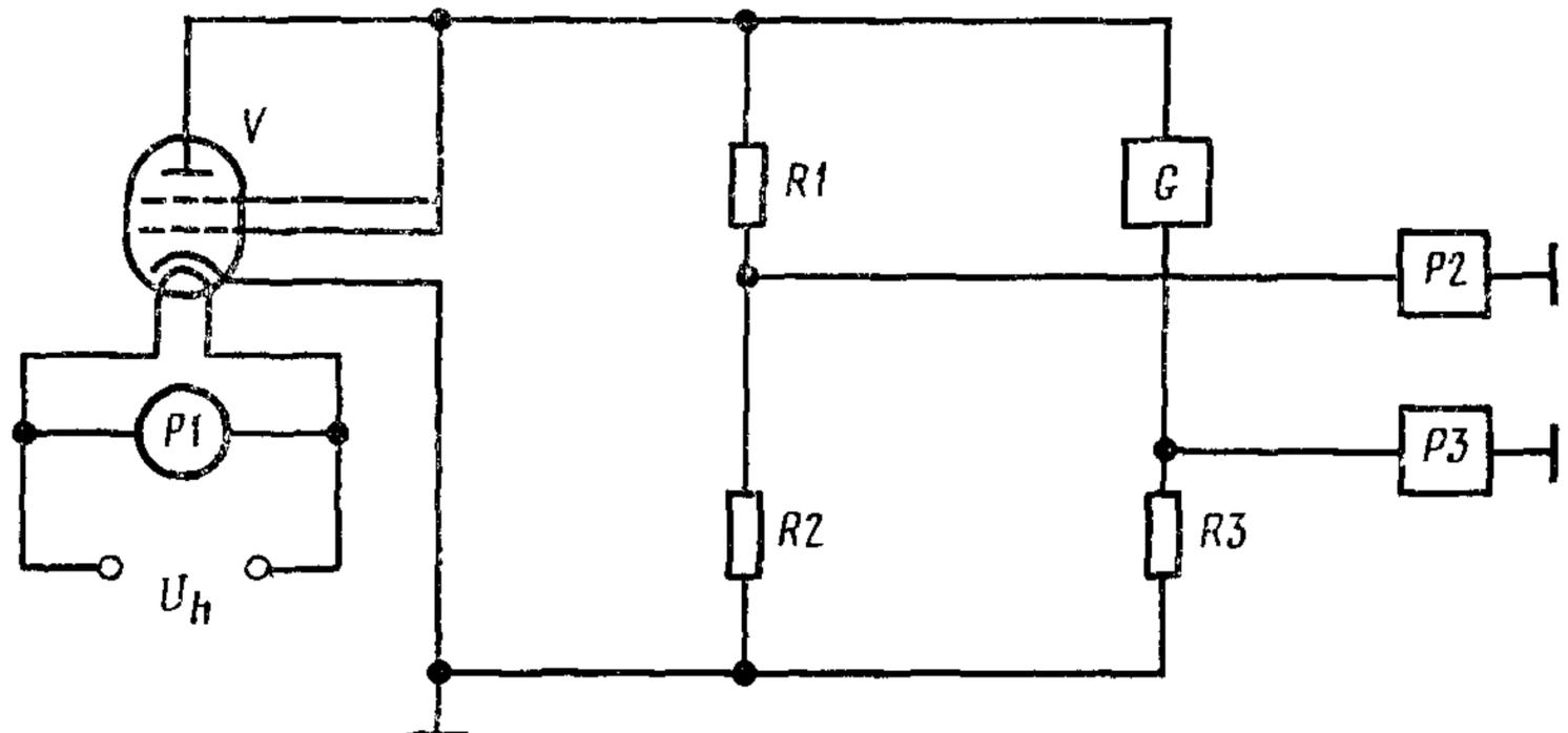
$G$ —генератор импульсов,  $P1$ —прибор для измерения переменного (постоянного) напряжения,  $P2, P3$ —приборы для измерения импульсного напряжения,  $R1R2$ —делитель напряжения,  $R3$ —измерительный резистор,  $V$ —испытываемая лампа
