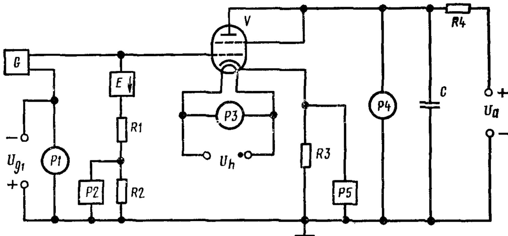
$C$ —накопительный конденсатор;  $G$ —генератор импульсов;  $P1, P3, P4$ —приборы для измерения постоянного (переменного) напряжения;  $P2, P5$ —приборы для измерения импульсного напряжения;  $R1R2$ —делитель напряжения;  $R3$ —измерительный резистор;  $R4$ —зарядный резистор;  $V$ —испытываемая лампа;  $E$ —электрoвакуумный или полупроводниковый диод.
