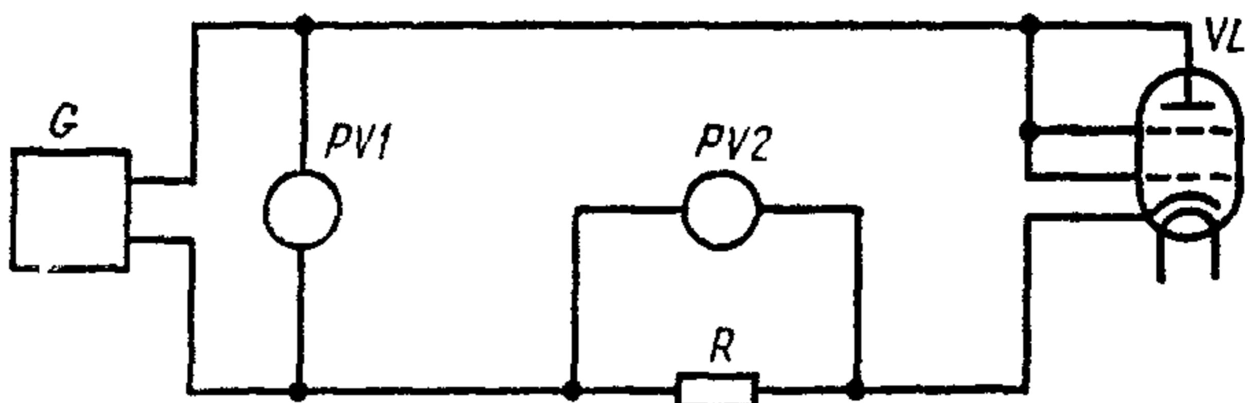
*PV1—PV2*—электронные импульсные вольтметры;
