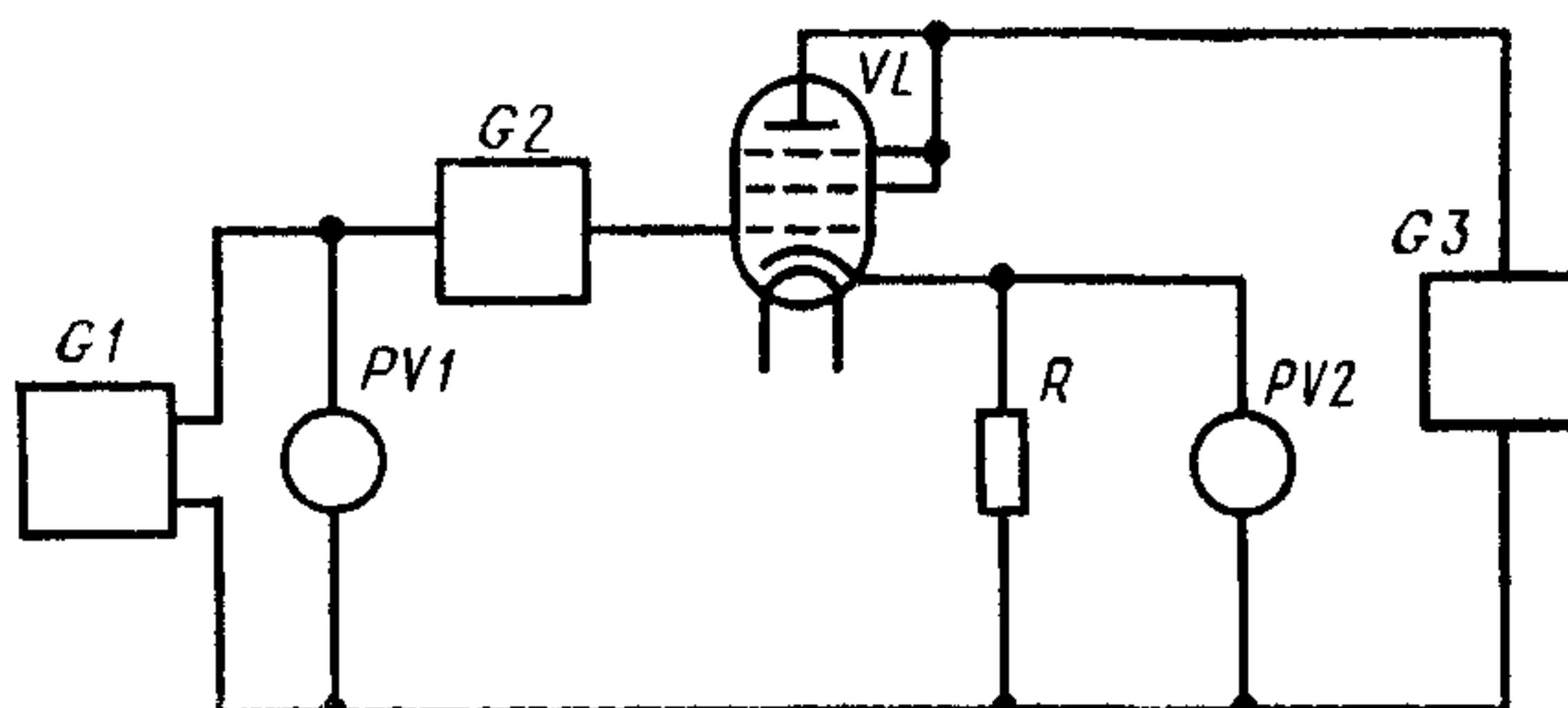
*PV1* и *PV2*—электронные импульсные вольтметры; *G1*—генератор импульсного напряжения; *R*—резистор; *VL*—испытуемая лампа; *G2*, *G3*—источники напряжения постоянного тока.
