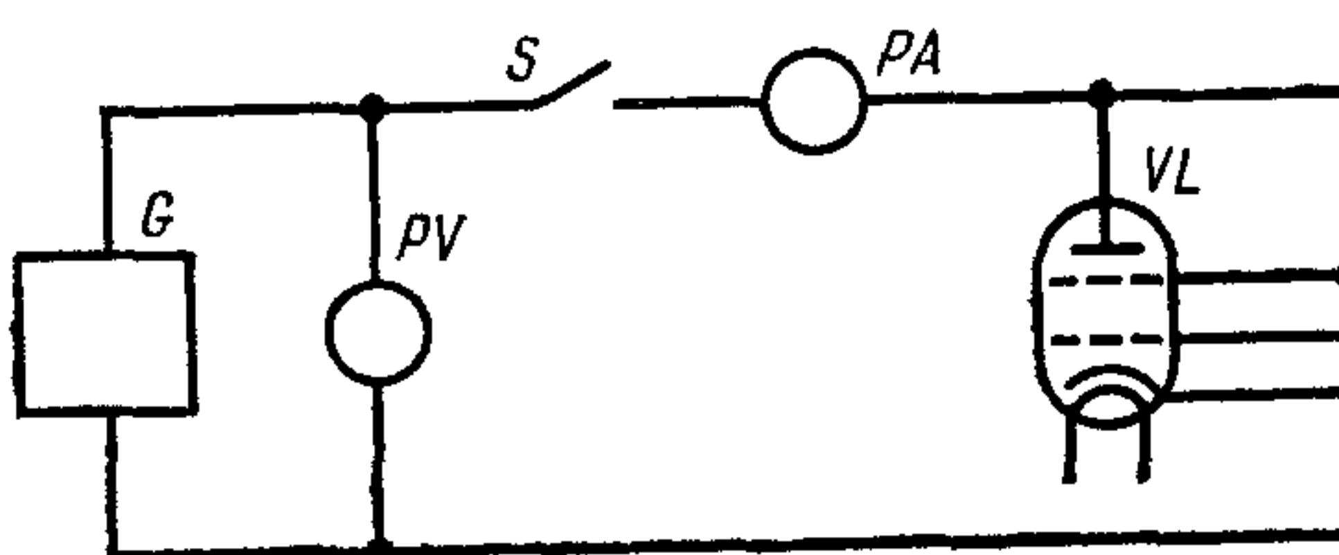
*PV*—вольтметр постоянного тока; *PA*—миллиамперметр постоянного тока; *S*—выключатель; *VL*—испытуемая лампа; *G*—источник напряжения постоянного тока.
