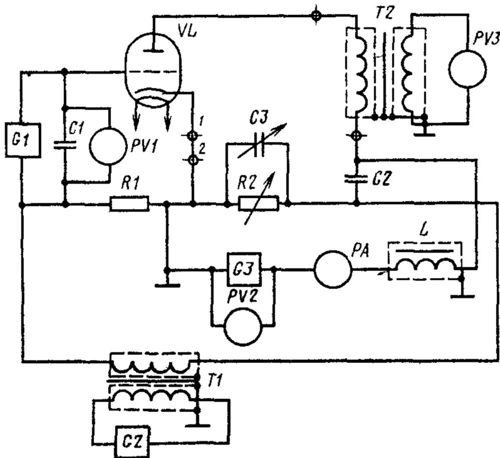
*VL*—испытуемая лампа; *T1*, *T2*—трансформаторы; *G1*, *G3*—источники постоянного напряжения; *G2*—генератор синусоидального напряжения; *R1*, *R2*—безындукционные резисторы; *C1*, *C2*—конденсаторы; *C3*—компенсирующий конденсатор; *PV1*, *PV2*—вольтметры; *PV3*—милливольтметр; *PA*—миллиамперметр; *L*—дроссель.
