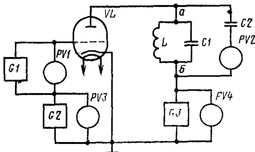
$PV1, PV2$ —милливольтметры или вольтметры;  $PV3, PV4$ —вольтметры;  $G1$ —генератор синусоидального напряжения;  $G2, G3$ —источники постоянного напряжения;  $VL$ —испытуемая лампа;  $C1, C2$ —конденсаторы;  $L$ —дрессель
