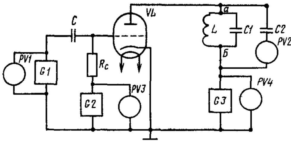
$C$ ,  $C1$ ,  $C2$ —конденсаторы;  $V_L$ —испытуемая лампа;  $L$ —дроссель;  $PV1$ ,  $PV2$ —милливольтметры или вольтметры;  $PV3$ ,  $PV4$ —вольтметры;  $G1$ —генератор синусоидального напряжения;  $G2$ ,  $G3$ —источники постоянного напряжения;  $R_c$ —резистор.
